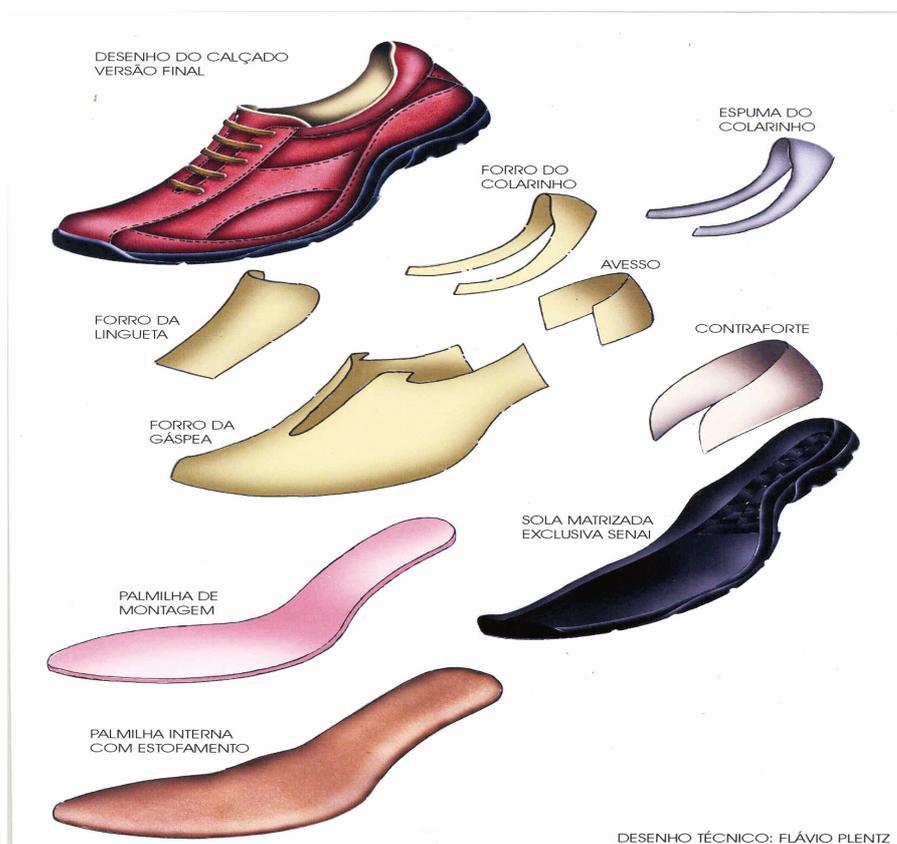
Figura 53- Componentes básicos na construção de um calçado
