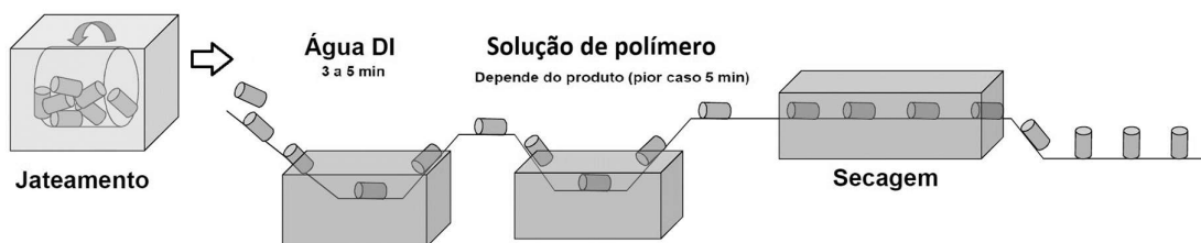
Figura 4: Etapas processo de polimerização para conformação à frio.
