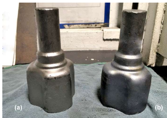
Figura 11: Peça antes, à esquerda, e depois da imersão no banho de nanocerâmico.
