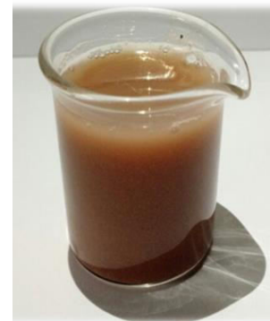
i. Lodo de ETE de um curtume que utiliza taninos vegetais na etapa de curtimento
