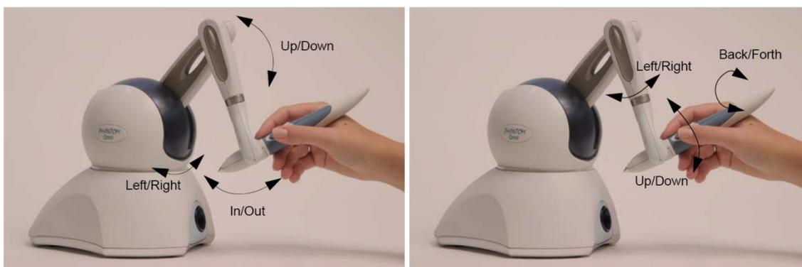
Figura 4.8 - Graus de liberdade do Phantom Omni
