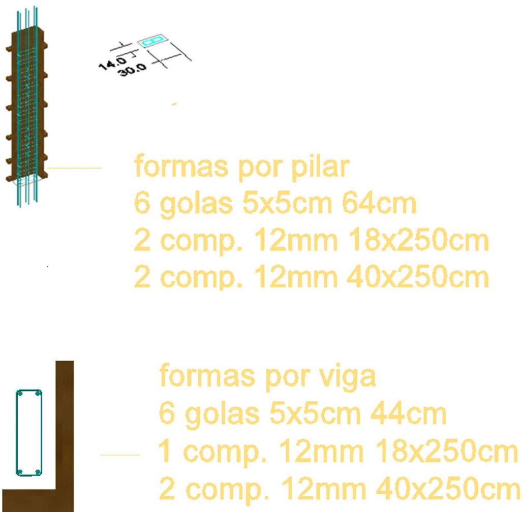
Figura 18-Formas de pilares e vigas
