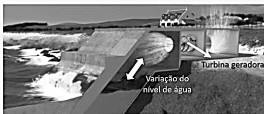
**(a) Dispositivos de coluna de água oscilante**
