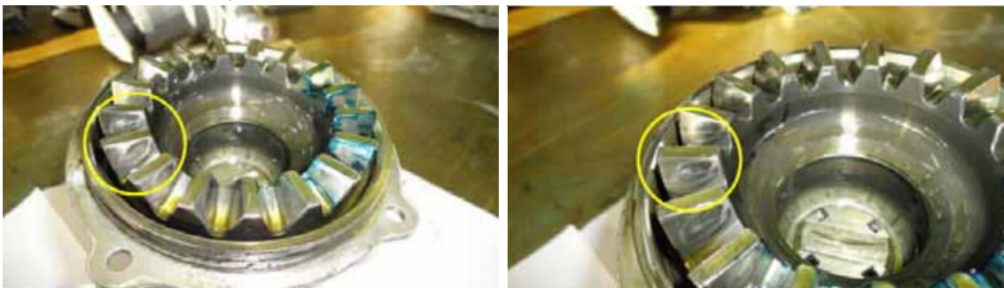
Figura 3.6: Superfície danificada da roda de engrenagem. (STUPAR; SIMONOVIC; JOVANOVIC, 2012)
