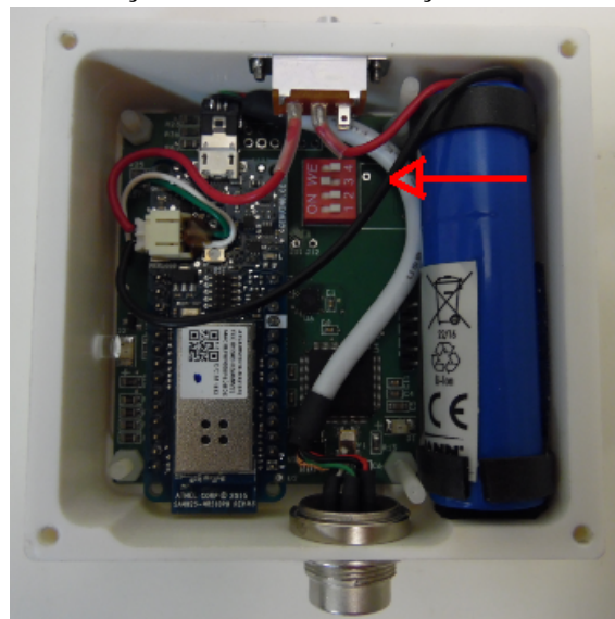
Figura 4.3: Localização do switch de seleção do número do módulo.
