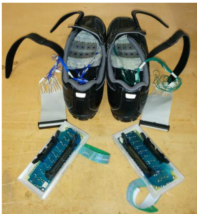
Figura 45 – Sapatilhas com as palmilhas instrumentadas e circuitos de condicionamento.
