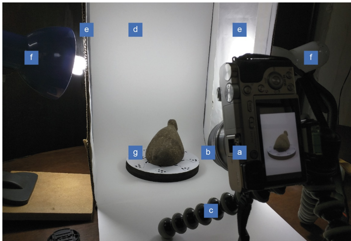
Ilustração 27 – Montagem da fotogrametria: (a) câmera fotográfica; (b) filtro polarizador circular; (c) tripé de mesa; (d) um mini estúdio; (e) difusores de luz; (f) duas luminárias de mesa; (g) base giratória.
