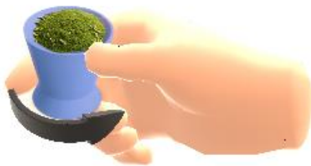
Figura 11. Dappen de silicone (recipiente) usado para secar e homogeneizar a erva-mate com solução de sacarose em estufa.
