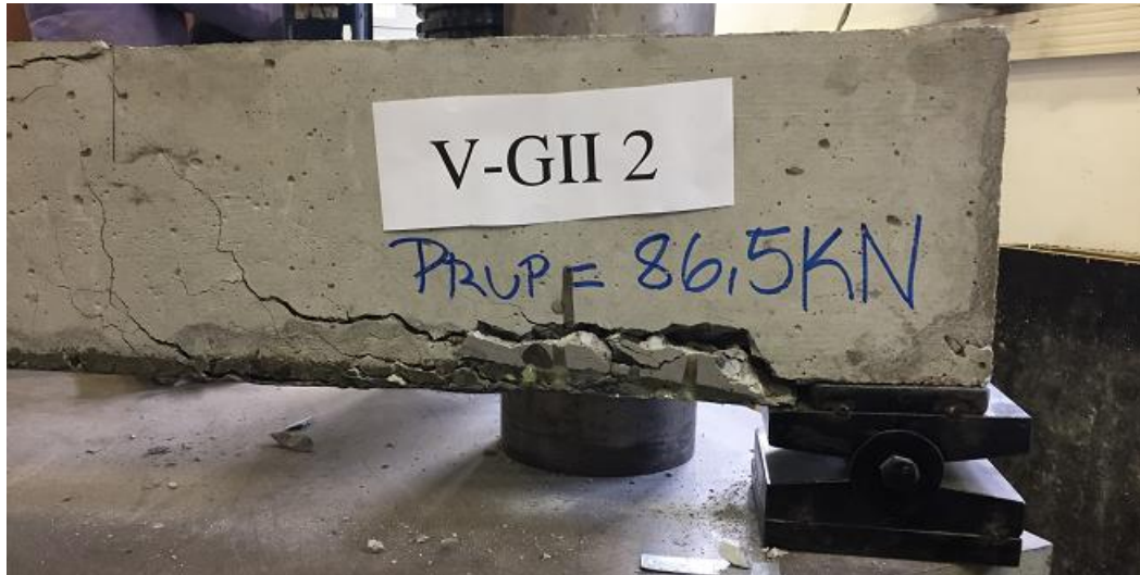
Figura 31 – Detalhe do rompimento da ancoragem da viga do Grupo II
