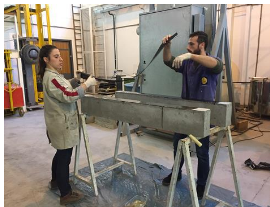
Figura 20b – Posicionamento da manta de fibra de carbono
