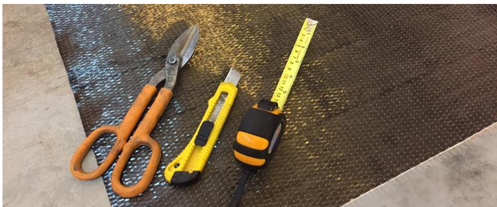
Figura 16 – Materiais utilizados para o corte da manta de fibra de carbono
