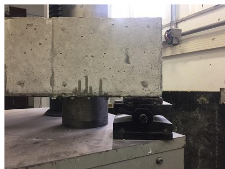
Figura 23b – Apoio de segunda ordem
