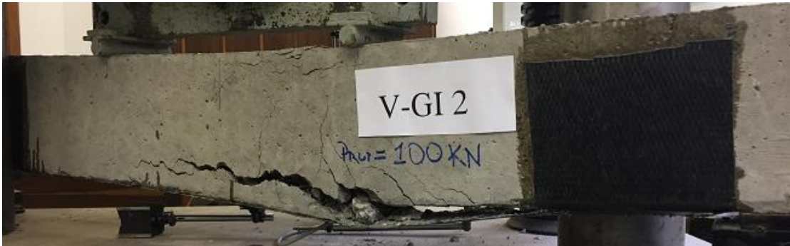
Figura 28 – Descolamento do reforço após deformações excessivas na região central do vão
