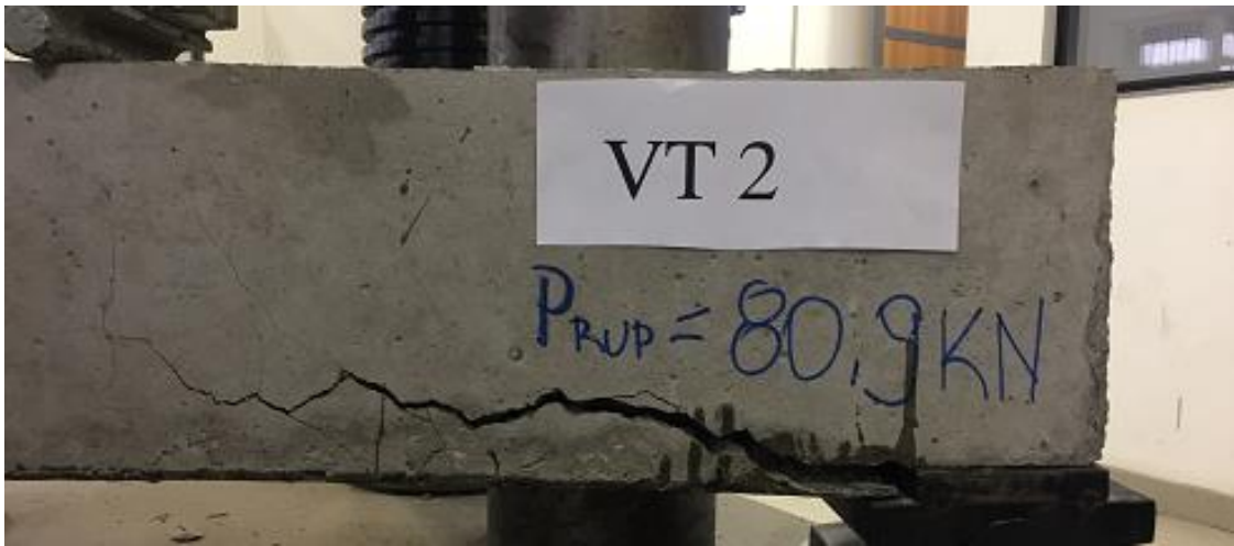
Figura 26: Detalhe da ruptura da VT – 2 na região próxima ao apoio
