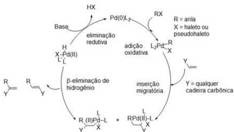
Figura 39: Mecanismo da reação Heck adaptada da referência 56b .
