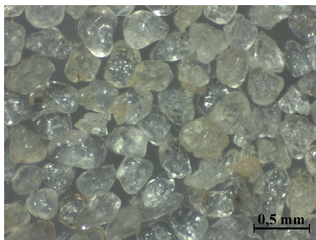
Figura 3. Abrasivos utilizados nos ensaios Roda de Borracha.
