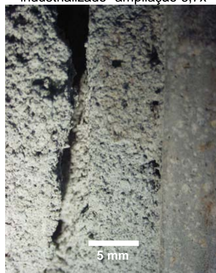
Figura 6.83 – Interface concreto 45 MPa com desmoldante lavado frio, chapisco industrializado, ampliação 6,7x
