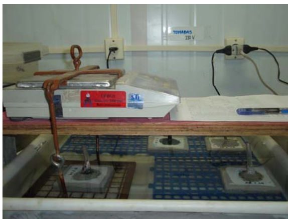
Figura 5.32 – Sistema montado para execução do ensaio de sucção capilar
