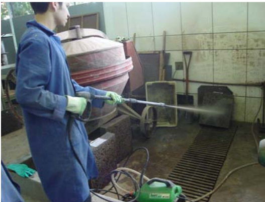
Figura 5.4 – Execução da lavagem a frio
