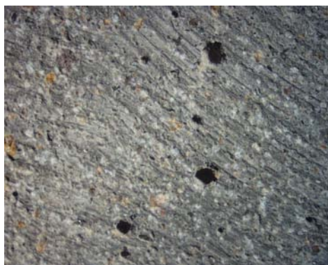
Figura 5.11 – Concreto 35 MPa (fcj) lixado – ampliação de 7,6X
