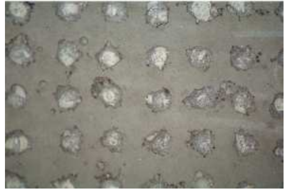
Figura 3.7 – Superfície apicoada parcialmente (JÚLIO, 2004)
