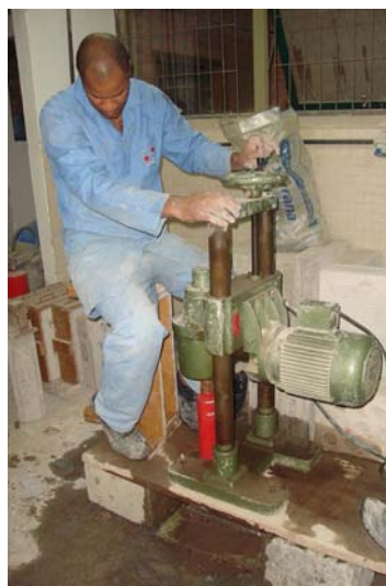
Figura 5.41 – Extração das amostras para avaliação da extensão de aderência
