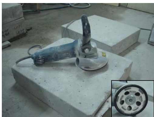
Figura 5.10 – Equipamento utilizado no lixamento, no detalhe, o disco
