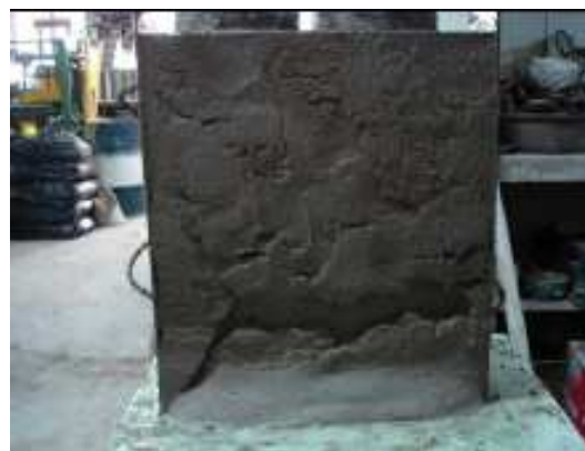
Figura 5.15 – Descolamento da argamassa fresca
