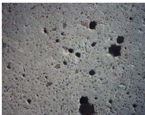
Figura 5.8 – Concreto 25 MPa (fcj) escovado – ampliação de 7,6X
