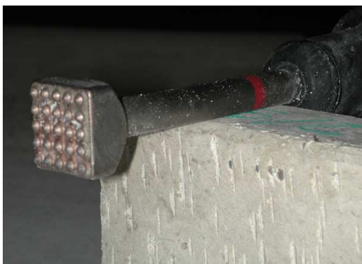
Figura 3.8 – Ponteira utilizada no equipamento para apicoamento total (CABREDO et al., 2003)
