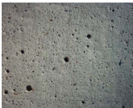
Figura 5.9 – Concreto 35 MPa (fcj) escovado – ampliação de 7,6X
