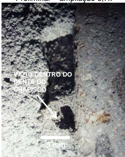
Figura 6.78 – Interface concreto 35 MPa escovado, ch ind, Estudo Preliminar, ampliação 6,7x
