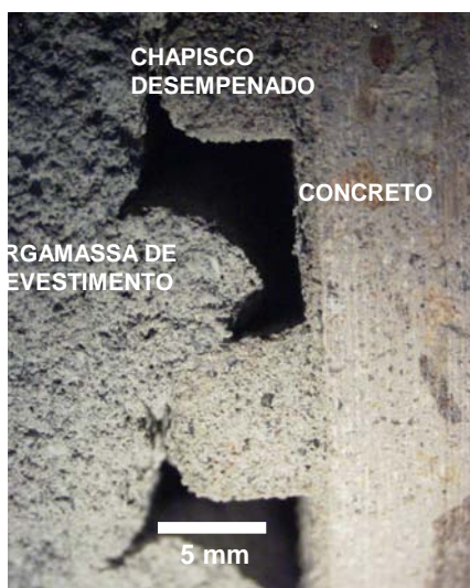
Figura 6.74 – Interface concreto 25 MPa – sem desmoldante, lavado, ch. Ind., Estudo Preliminar; ampliação 6,7x
