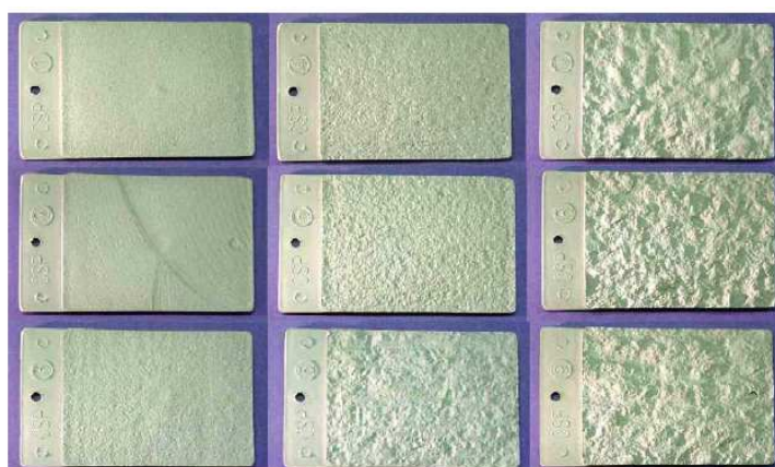
Figura 4.9 – Modelos Plásticos dos perfis de superfície do concreto (GALECKI et al., 2001, 2006)
