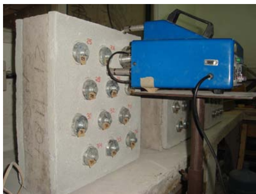
Figura 5.39 – Ensaio de resistência de aderência
