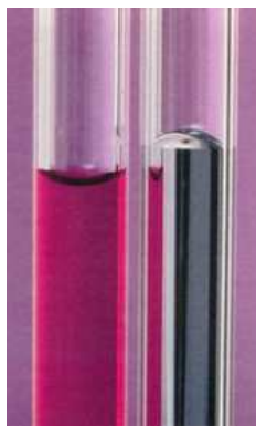
Figura 2.2 –Capilar de vidro à esquerda contendo a água (forma côncava); capilar de vidro à direita contendo mercúrio (forma convexa). (Atkins, 2001 apud JUNIOR, 2007)
