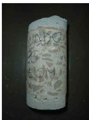
Figura 5.43 – amostra extraída para análise da extensão de aderência
