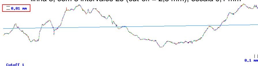
Figura 6.23 – Perfil de rugosidade do concreto 45 MPa, escovado, linha 3, com 1 intervalo Le ( cut-off = 8 mm), escala 0,01 mm
