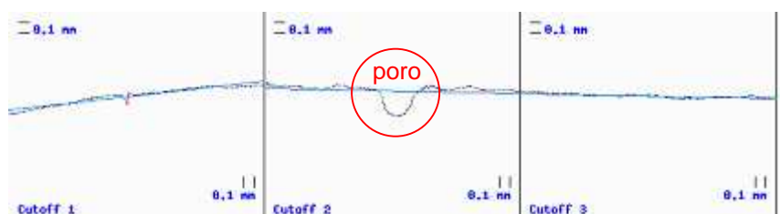
Figura 6.5 – Perfil de rugosidade do concreto 25 MPa, escovado, linha 1, com 3 intervalos Le ( cut-off = 2,5 mm), (no detalhe, poro) escala 0,1 mm
