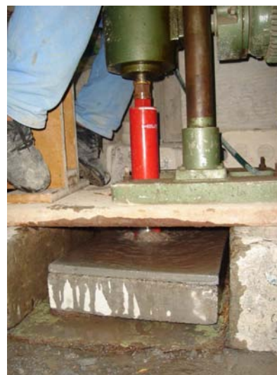
Figura 5.42 – Detalhe da extração das amostras para avaliação da extensão de aderência
