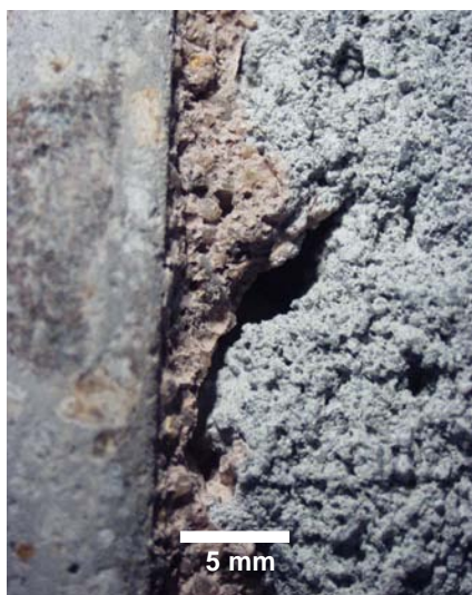
Figura 6.71 – concreto 45 com desmol lavado frio, ampliação de 6.7x
