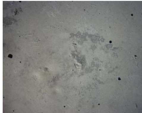
Figura 5.7 – Superfície do concreto 25 MPa (fcj) lavada com maior exposição dos poros – ampliação de 7,6X
