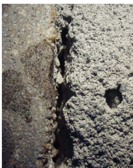
Figura 6.86 – Interface concreto 25, retardador de pega de superfície, sem chapisco, Estudo Preliminar, ampliação 6,7x
