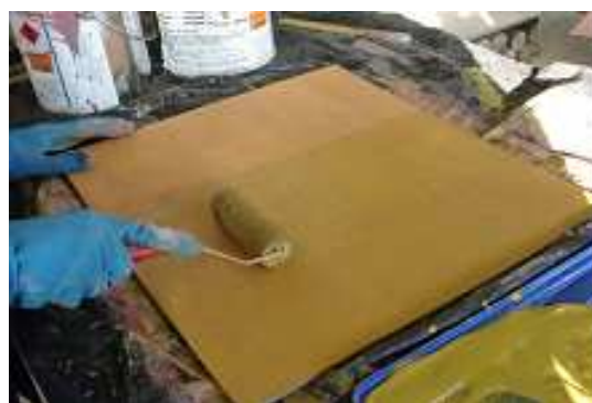
Figura 5.17 – Aplicação da segunda demão do retardador de pega de superfície
