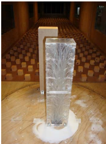
Figura 5.18 – Modelo de tomadas de pressões do CAARC Standard Tall Building .
