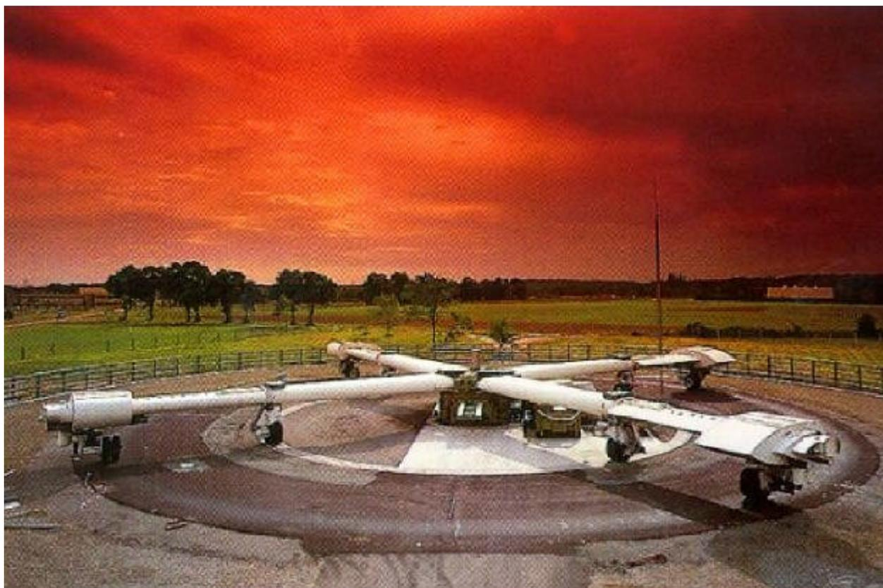
Figura 2.4 – Vista do simulador do *LCPC Circular Test Track*.
