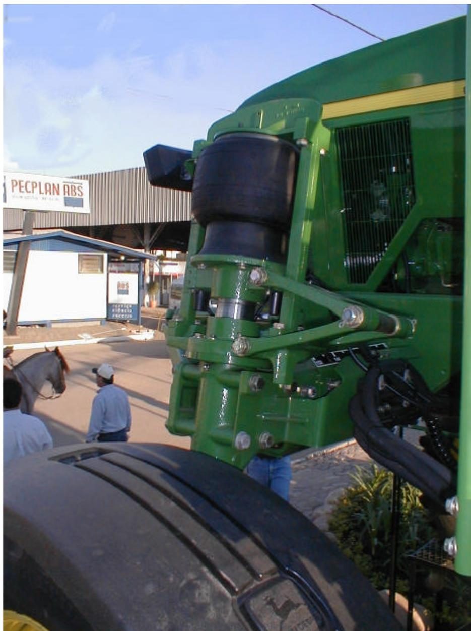
Figura 2.31 – Detalhe da suspensão do Pulverizador *John Deere 4700*.
