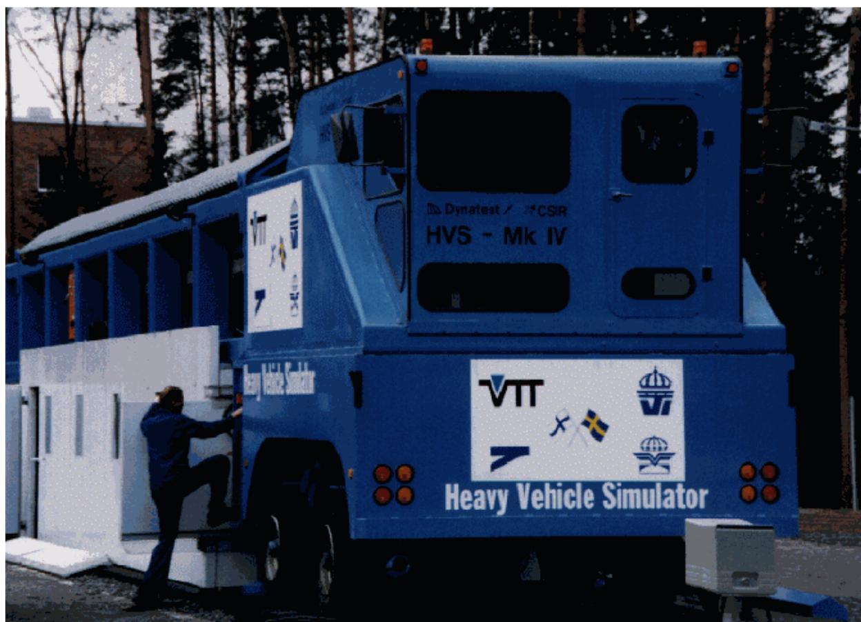
Figura 2.18 – Vista geral destacando o sistema de climatização do *HVS IV*.
