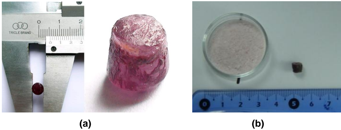
Figura 10: a) Foto do compacto AuHF3,2 em escala normal e ampliada b) Foto do xerogel AuHF3,2 pó e compacto
