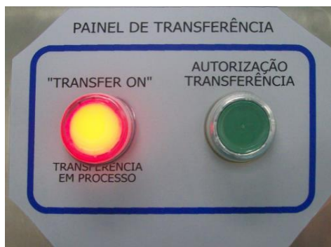
Figura 10 - Painel de transferência, responsável por realizar a autorização de transferência do Flúor-18 do ciclotron para o V-vial.
