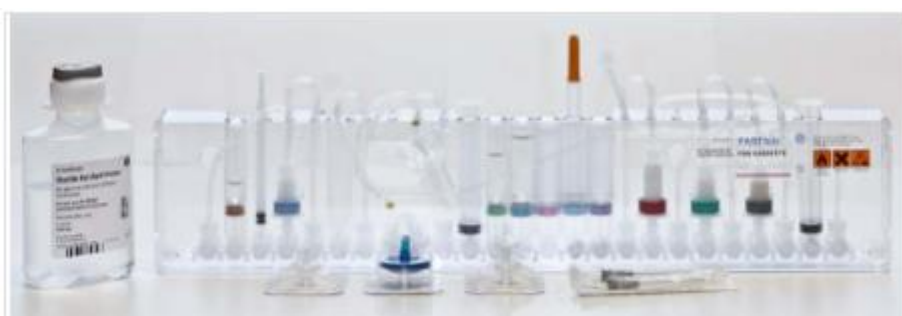
Figura 9 - O cassete do Sintetizador Fastlab®, para a produção de FDG com todos os seus componentes.
