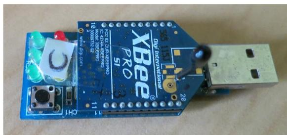
**Figura 6.2. Módulo receptor a ser conectado no computador.**
