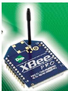
Figura 0.4. Módulo XBee [Digi International].
