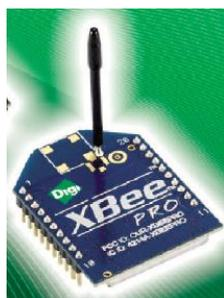
Figura 4.2. Módulo XBee (Digi International).
