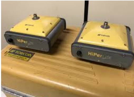
Figura 13 - Receptores GNSS modelo HIPPER LITE, fabricante TOPCON
