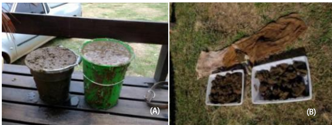
Figura 31- (A) Lodo coletado (SA) e; (B) Após 3 dias de desidratação. (Fonte: A Autora, 2013)
