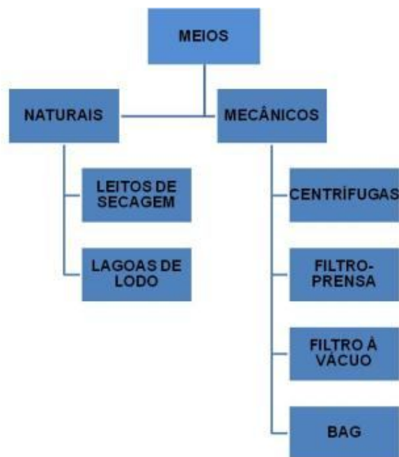
Figura 14- Processos mais utilizados na redução de volume - desidratação (Fonte: Adaptado de Reali (1999))
