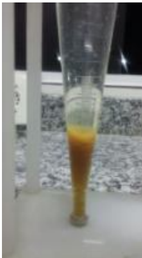
Figura 38- Flocos decantados no final de um teste em Cone Imhoff (Fonte: A Autora, 2017)
