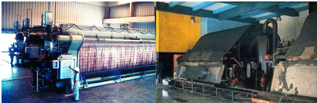
Figura 17- Conjuntos de filtros-prensa da Estação Barueri São Paulo (esquerda) e um filtro à vácuo (direita) (Fonte: DEGRÉMOND, 2007).
