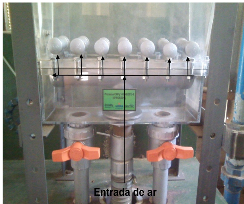
Figura C4 – Vista lateral do distribuidor de ar da planta de bancada.
