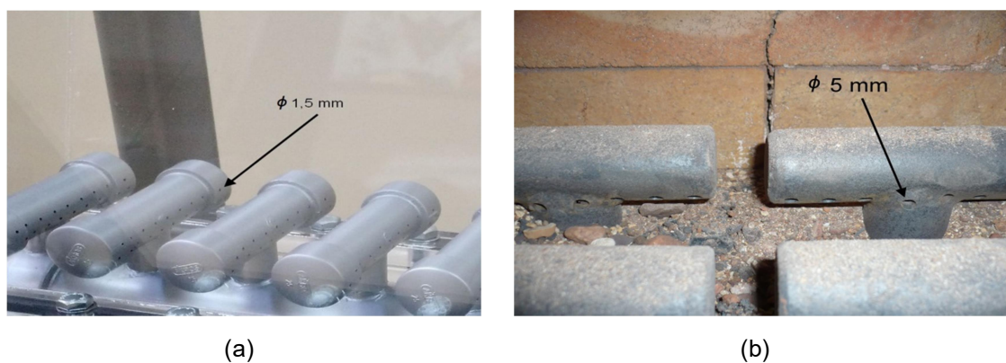
Figura 12 – Detalhe do distribuidor de ar da planta de (a) bancada e (b) piloto.
