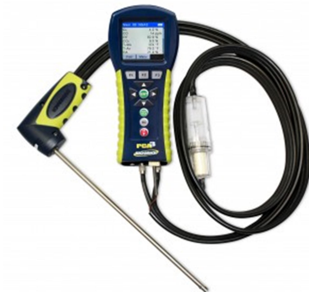
Figura C10 – Analisador de gases portátil PCA3 utilizado na planta piloto.
