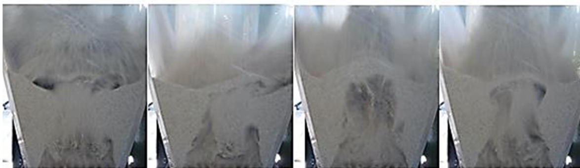
Figura 32 – Sequência de bolhas observadas na parede lateral da planta de bancada, concentradas na região central do reator.
