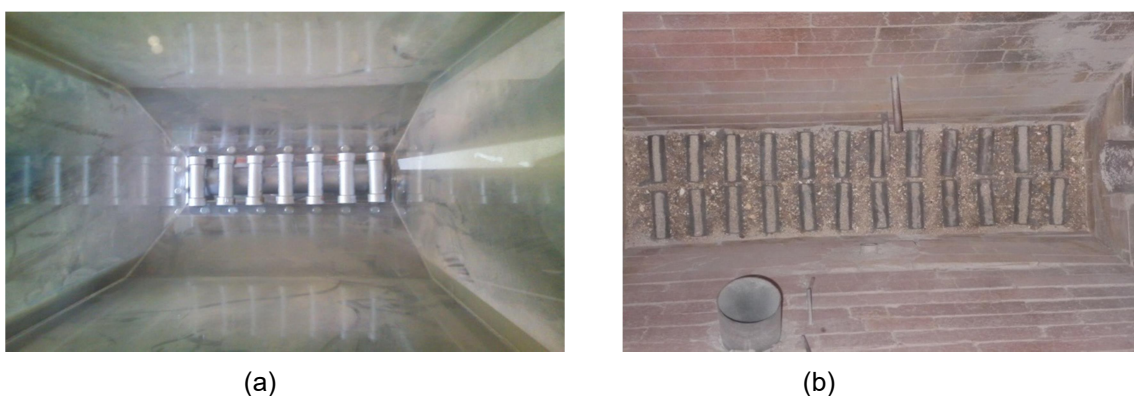
Figura 11 – Vista superior do conjunto de tubos formadores do distribuidor de ar da (a) planta de bancada e da (b) planta piloto
