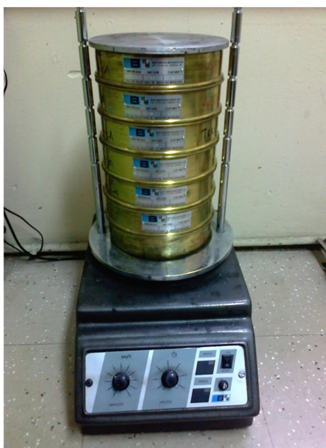
Figura 8 – Peneira e base vibratória utilizada para a determinação do diâmetro médio d_{ps} .
