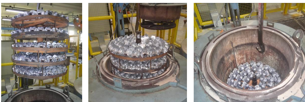
Figura 3.2 - Ciclo de carregamento do forno (fonte: autor)
