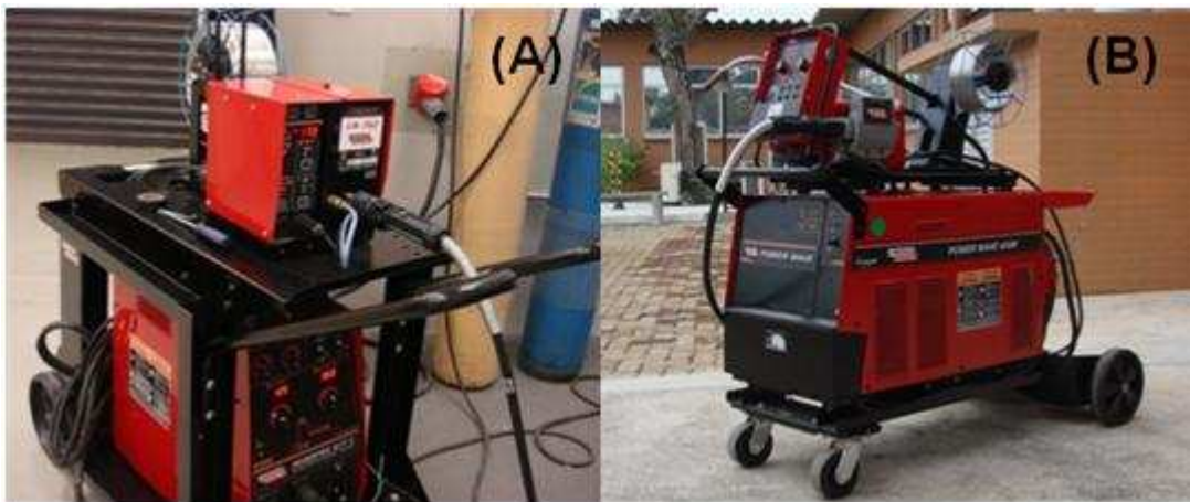
Figura 49: Fontes utilizadas na soldagem. (A) Invertec STT ® II .(B) Power Wave 455M.
