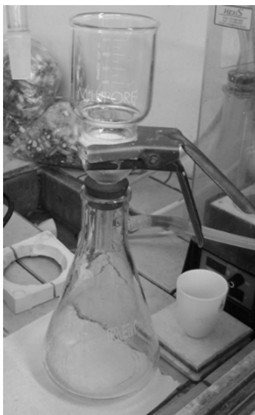
Fig. 23. Esquema de filtração por vácuo usando membrana para medição de sólidos suspensos.
