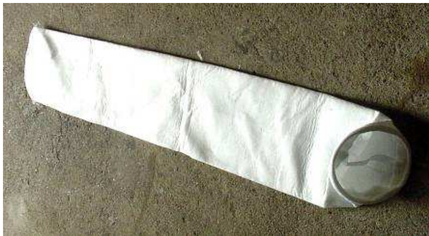
Fig. 36. Aspecto de filtro utilizado para DEA rica.
