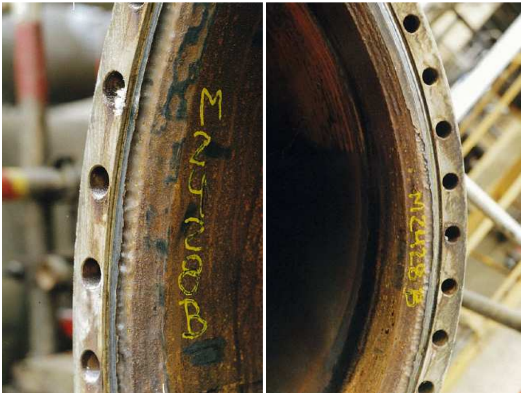
Fig. 16. Peça sob ataque severo, incluindo provável corrosão por produtos de degradação da DEA, no refeedor da torre regeneradora. Fonte: Arquivos internos da IE/RPBC.
