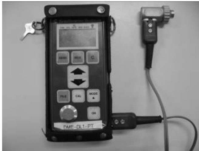
Fig. 24. Modelo DME-DL da Krautkramer Branson.
