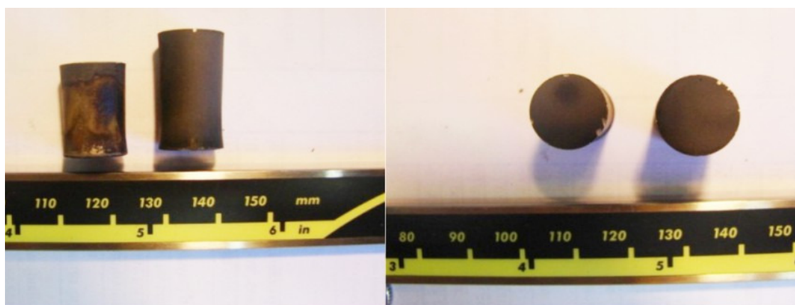
Figura 57: Corpos de prova após sinterização.
