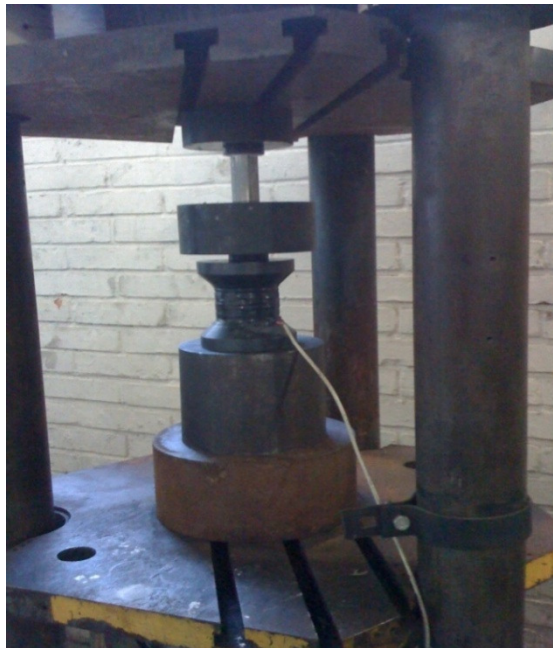
Figura 46: Matriz montada em equipamento para produção dos implantes
