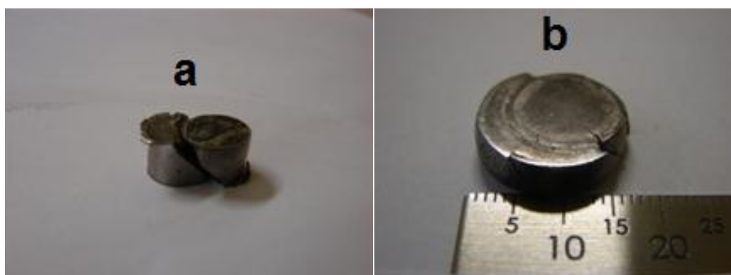
Figura 60: a) à esquerda, corpo de prova (sinterizado 3h) b) à direita, corpo de prova (sinterizado 2h).
