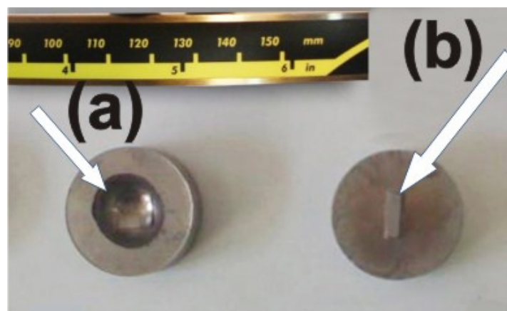
Figura 66: (a) Relevo para facilitar osseointegração (b) marca causada pelo inserto da matriz.
