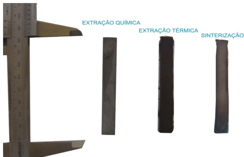
Figura 61: Corpos de prova “verdes” produzidas com diferentes parâmetros de injeção.
