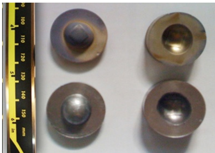
Figura 64: Na parte inferior, as peças “verdes”. Na parte superior, as peças após a sinterização
