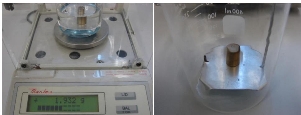
Figura 36: Montagem para a medida da massa de empuxo.
