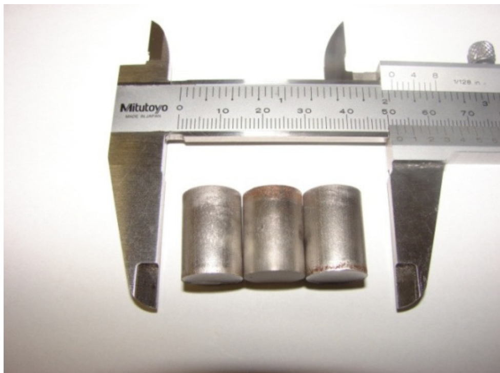
Figura 29: Corpos de prova compactadas de Ti a 600MPa.
