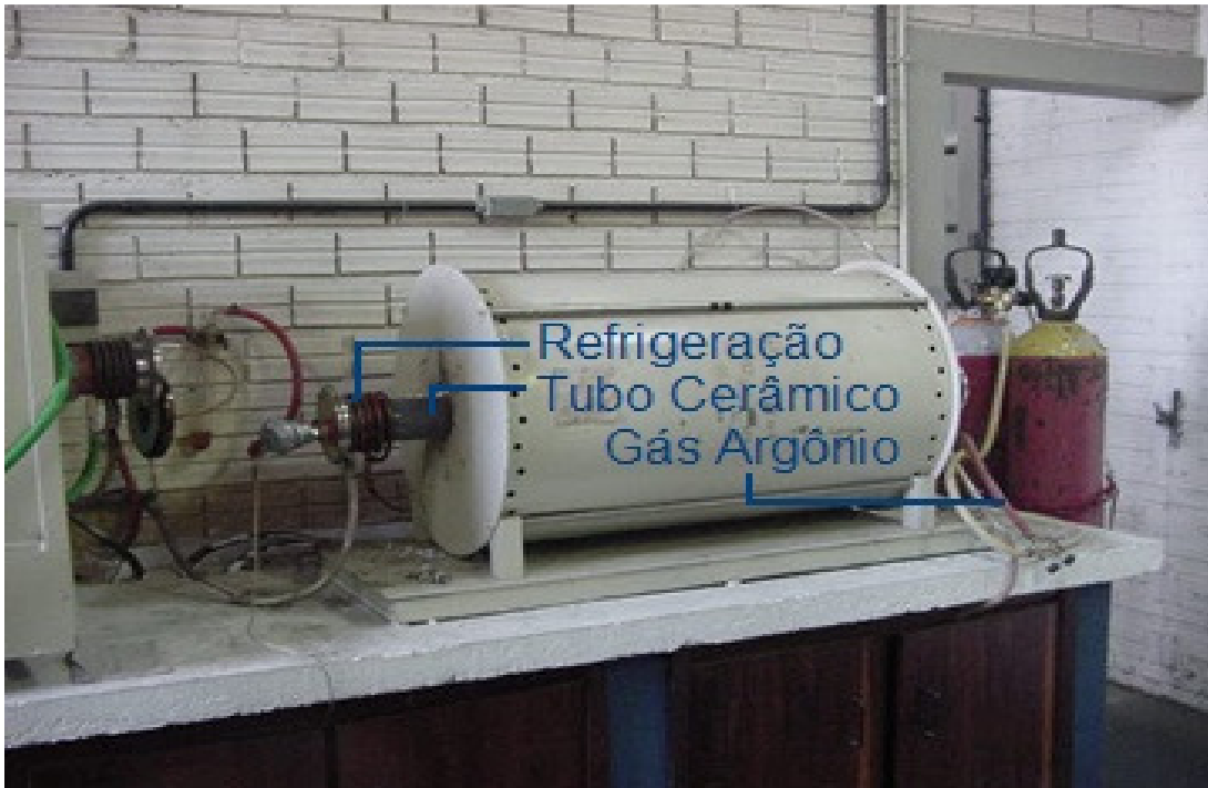
Figura 33: Forno tubular tipo mufla disponível no LdTM/UFRGS.
