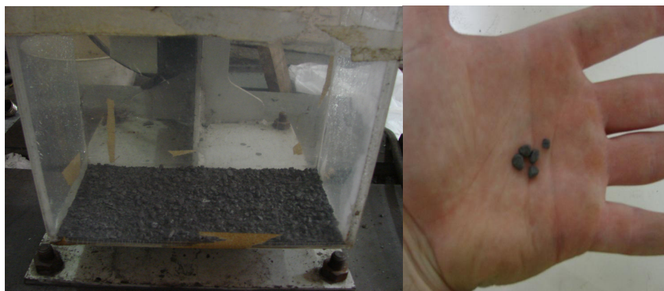
Figura 39: Carga pelletizada e pronta para ser injetada.
