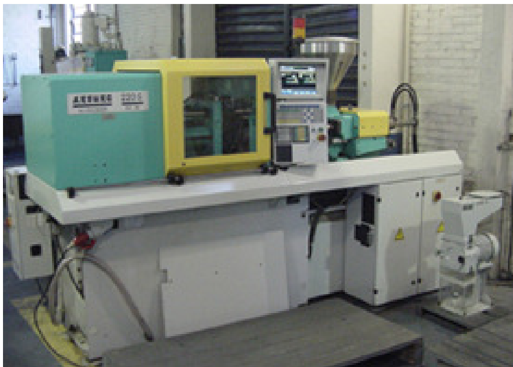
Figura 40: Injetora de alta pressão ARBURG® modelo ALLROUNDER 220S disponível no LdTM.
