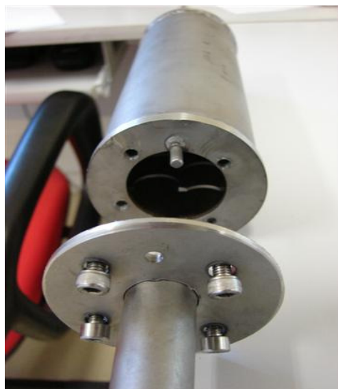
Figura 32: Câmara de Aço INOX AISI 302 projetada e construída para minimizar a contaminação dentro do forno.
