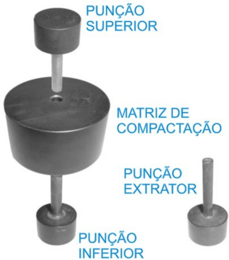
Figura 28: Matriz de compactação e punções fabricados no LdTM/UFRGS para obtenção dos corpos de prova de 13mm de diâmetro.
