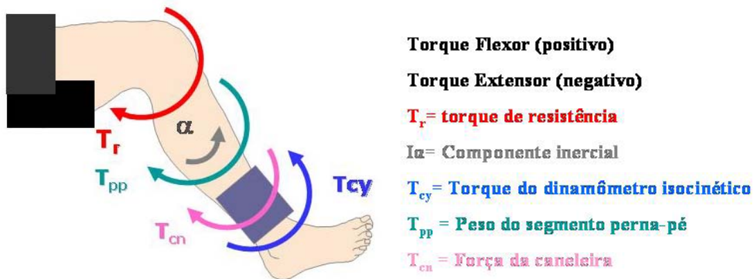
Figura 3.7 1 – Torques considerados para determinação do T_r . A figura representa o início da extensão.
