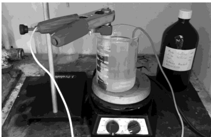
Figura 45 - Amostra e eletrodo de chumbo dentro da solução ácida sobre agitador magnético.
