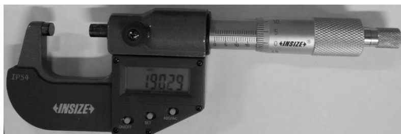
Figura 47 - Micrômetro utilizado para medir o diâmetro das amostras antes e depois do ataque eletrolítico.
