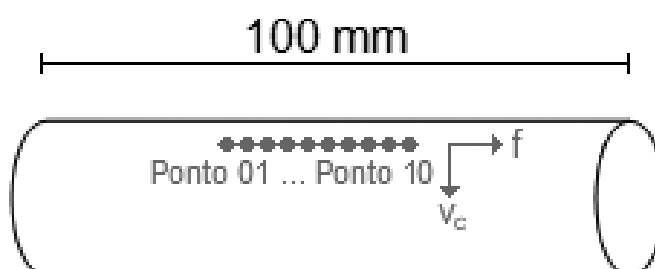
Figura 43 - Diagrama dos dez pontos sobre a amostra utilizados para verificar a homogeneidade das tensões residuais na superfície.
