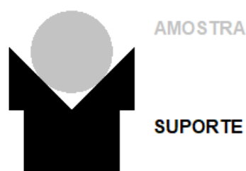
Figura 35 – Diagrama da amostra sobre base metálica para medição da rugosidade.
