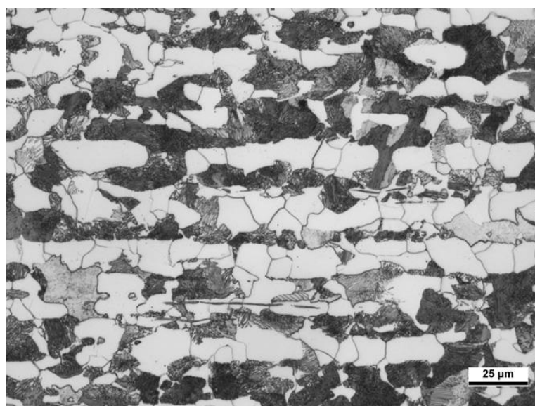
Figura 31 - Micrografia do material utilizado obtida a partir de um corte na direção longitudinal e ataque com Nital 2%.
