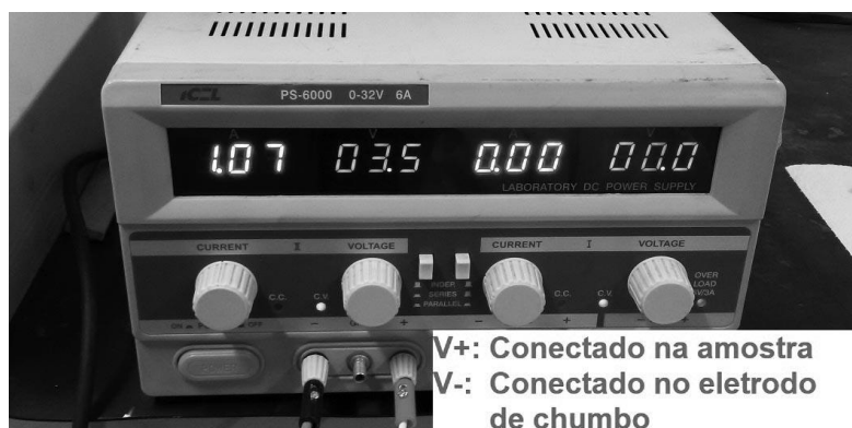
Figura 46 - Fonte de tensão utilizada na remoção de camadas das amostras e ligações do eletrodo de chumbo e da amostra.
