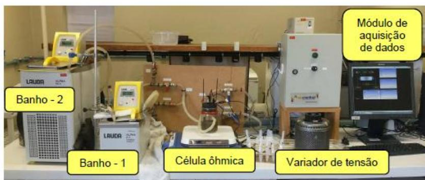
**Figura 3.1:** Equipamento de aquecimento ôhmico utilizado nos experimentos. FONTE: BAGATINI, 2018.
