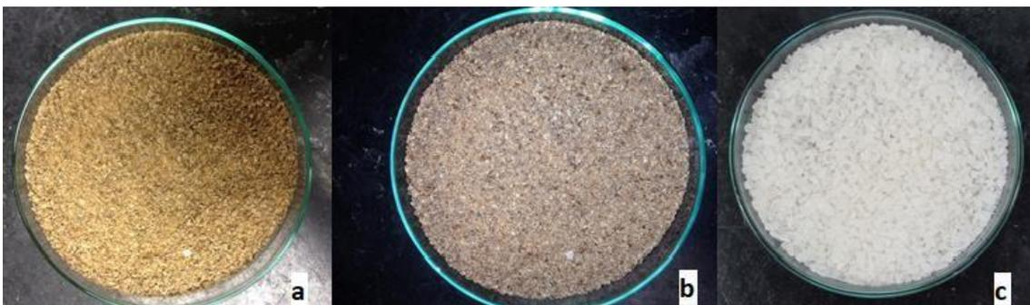
Figura 23 - a- Flakes de fibra vegetal longa com PLA; b- flakes de fibra vegetal curta com PLA; c- flakes de PLA virgem.
