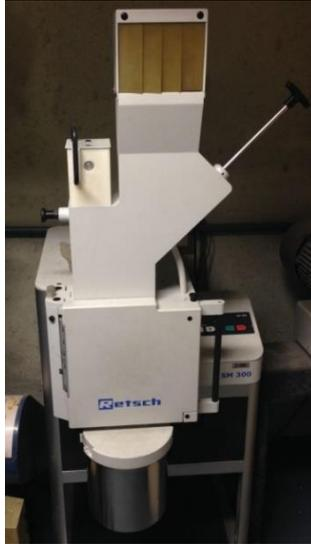
Figura 24 - Moinho de facas utilizado para a redução de tamanho das amostras.
