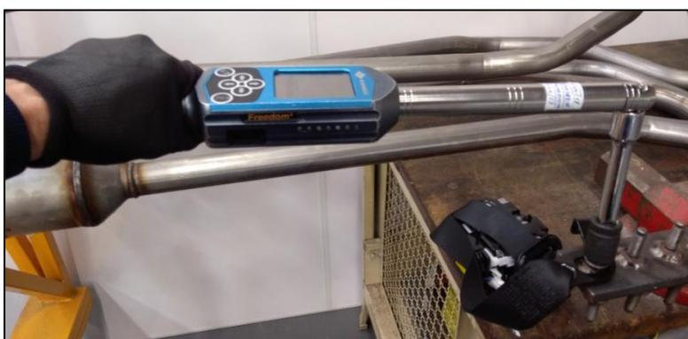
Figura 5.2 – Medição de torque de remoção das porcas através de torquímetro digital. Fonte: Autor
