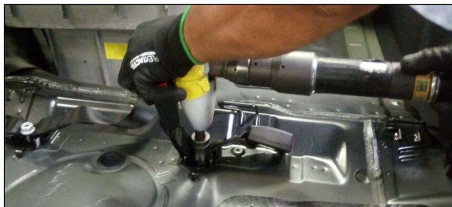
Figura 1.1 – Operação de fixação do cinto de segurança traseiro através de junta aparafusada com elementos de travamento. Fonte: Autor
