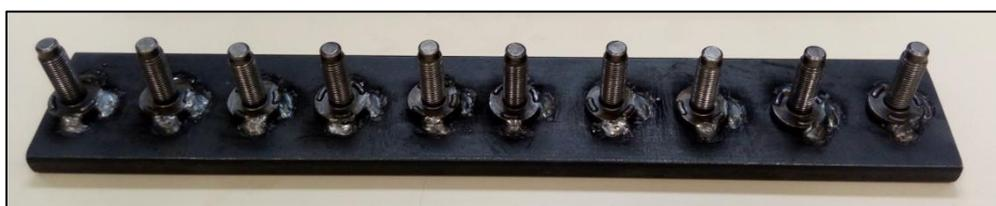
Figura 4.4 – Bancada protótipo para aquisição das curvas de aperto e no detalhe, parafuso utilizado para a fixação. Fonte: Autor.
