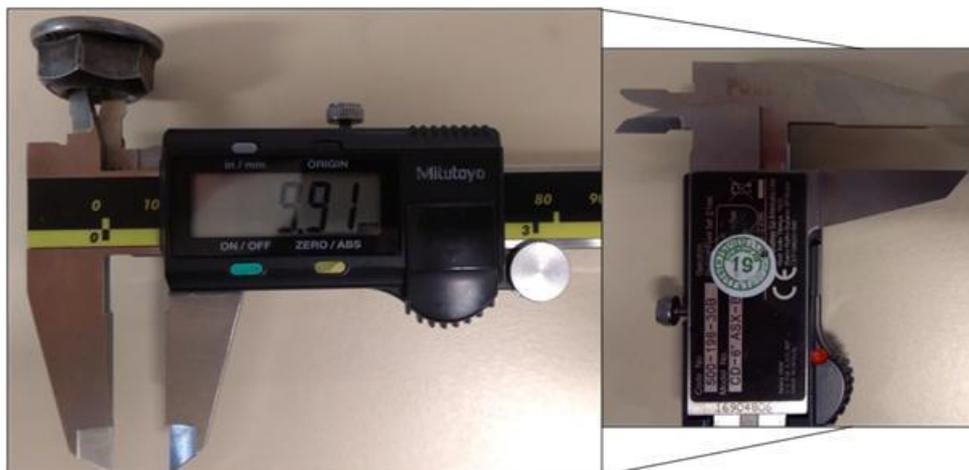
Figura 4.2 – Medição de diâmetro interno e rótulo de instrumento calibrado. Fonte: Autor
