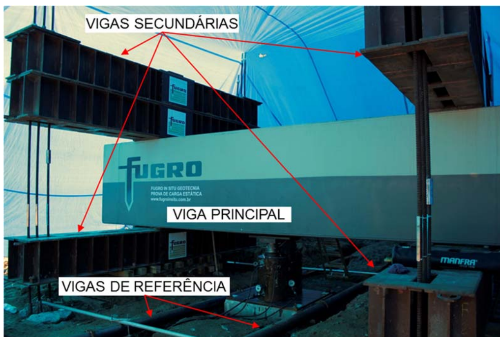
Figura 4-29 – Sistema de reação utilizado durante as provas de carga estática de topo
