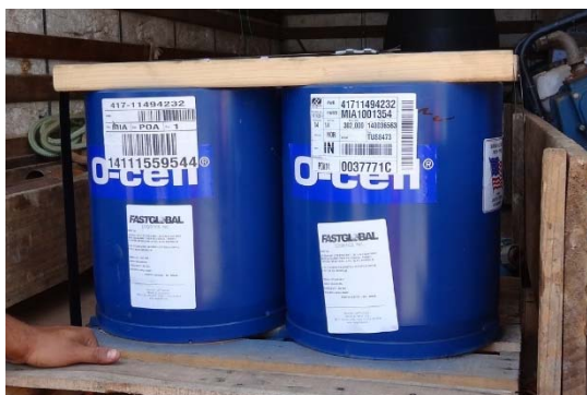
Figura 4-36 – Células expansivas ( O-Cell ) utilizada para realização do ensaio bidirecional na ET-06
