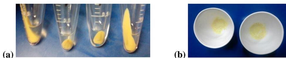
Figura AII.1 – Fotografias dos pós obtidos via extração a partir das amostras LC-NP<sub>x</sub> em duas etapas do processo: (a) precipitados obtidos após a lavagem com água, (b) pós secos sob pressão reduzida.
