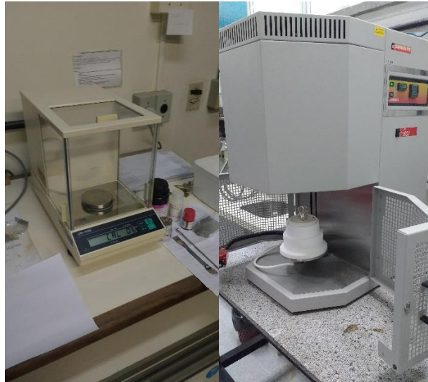
Figura 8: Balança de precisão e forno usados na preparação dos vidros.
