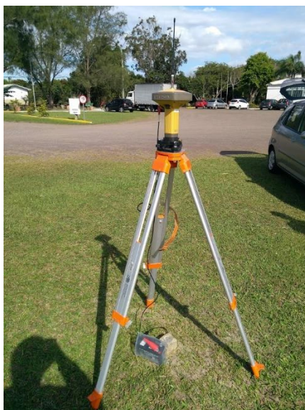
Figura 29 - Levantamento GNSS da base localizada no CECLIMAR Fonte: O Autor
