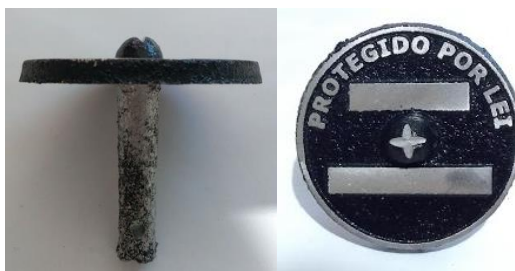
Figura 24 - Plaqueta metálica dos vértices Fonte: O Autor
