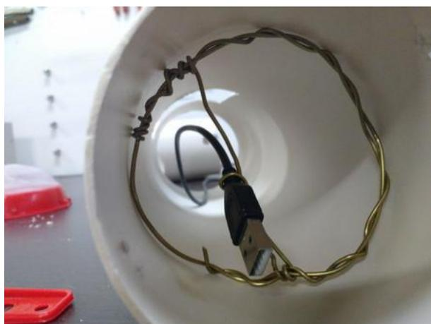
Figura 10: Detalhe dos arames enrolados para segurar o sensor, na foto representado pelo cabo USB.
