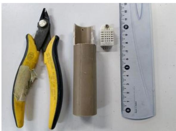
Figura 19: Da esquerda para direita, alicate de corte, PVC cortado, DHT22 e uma régua.
