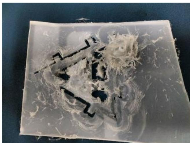
Figura 3: Resultado de um corte no qual lascas da chapa aderiram a fresa e passaram a contribuir no corte.
