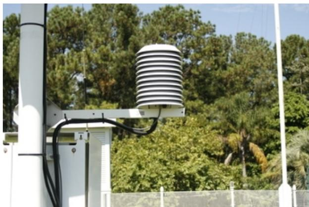
Figura 3.22: Abrigo meteorológico da estação A801, do INMET, usado como abrigo de referência.
