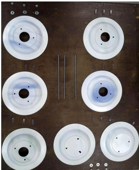
Figura 24: Peças do abrigo dispostas na sequência de montagem.
