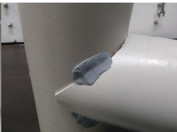
Figura 11: Detalhe do da cola epoxi usada para tapar os buracos entre os dois canos.
