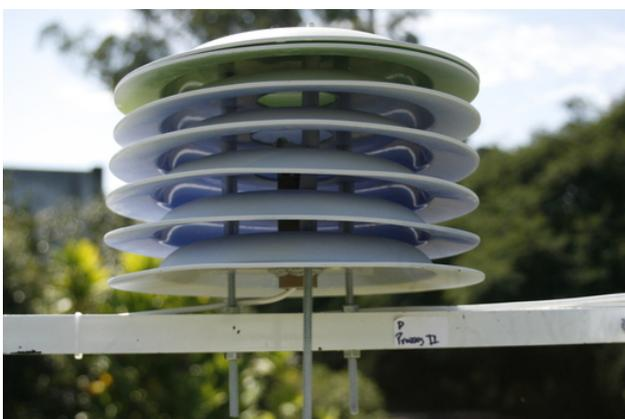
Figura 3.15: Abrigo Pratos II instalado no INMET.
