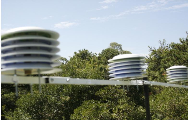
Figura 3.17: Visão geral dos três abrigos Pratos instalados no INMET; da esquerda para direita, abrigo I, II e III.
