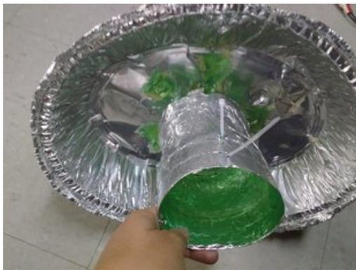
Figura 27: Visão inferior do abrigo Pet. É possível ver a entrada de ar inferior e o teto feito com a assadeira. A cinta plástica usada para fixar na estação o atravessa
