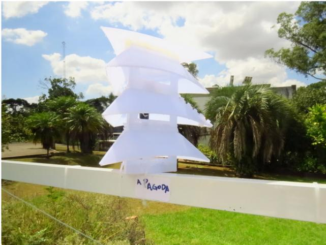
Figura 3.5: Abrigo Pagoda instalado no INMET; é possível verificar as cintas plásticas usadas para fixá-lo na barra.
