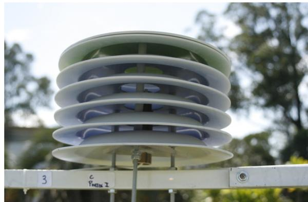
Figura 3.14: Abrigo Pratos I instalado no INMET.
