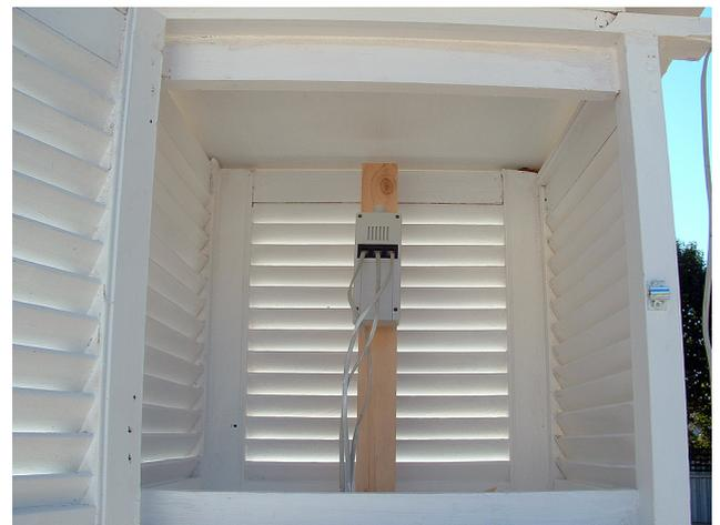
Figura 2.2: Abrigo de Stevenson de madeira, com parede simples. Foto por Bidgee, CC BY 3.0
