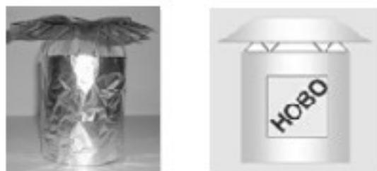
Figura 3.18: A esquerda, foto do abrigo montado; a direita, desenho de protótipo do modelo. Imagens retiradas de Barbosa et al. (2008).
