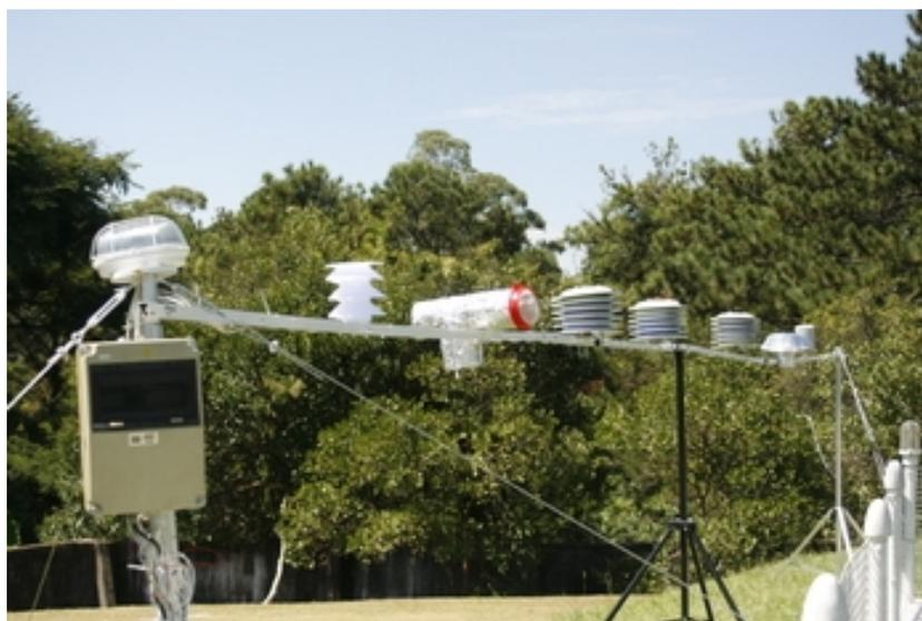
Figura 3.1: Estação meteorológica e seus 7 abrigos durante um ensolarado dia no INMET.
