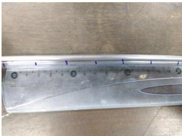
Figura 21: Mangueira de nível marcada para o corte.
