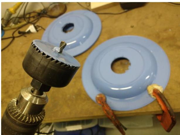
Figura 13: Furo central realizado com a serra copo em destaque.
