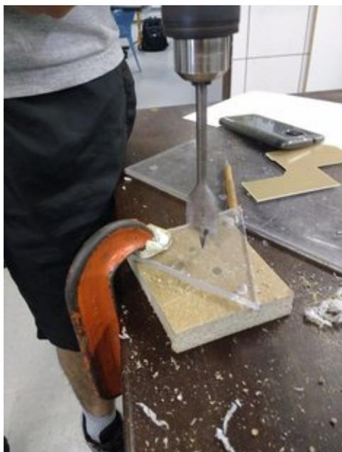
Figura 17: Furo central do acrílico feito com uma broca de madeira.
