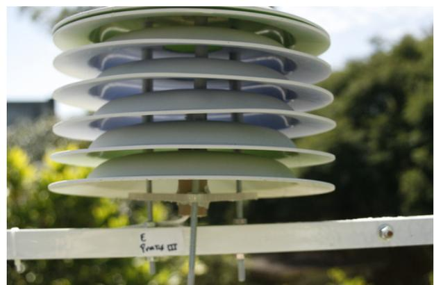
Figura 3.16: Abrigo pratos III instalado no INMET.
