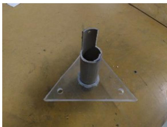
Figura 20: Resultado final da peça de fixação do sensor.
