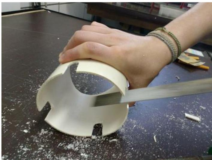
Figura 7: Cortes de encaixe do ventilador sendo lixados com uma lima de metal.
