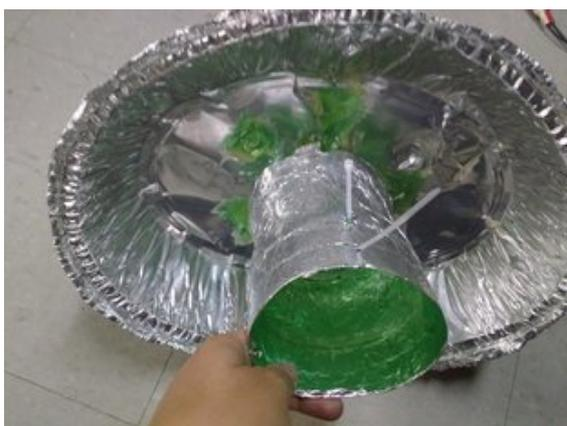
Figura 3.20: Visão inferior do abrigo Pet. É possível ver a entrada de ar inferior e o teto feito com a assadeira. A cinta plástica usada para fixar na estação o atravessa.
