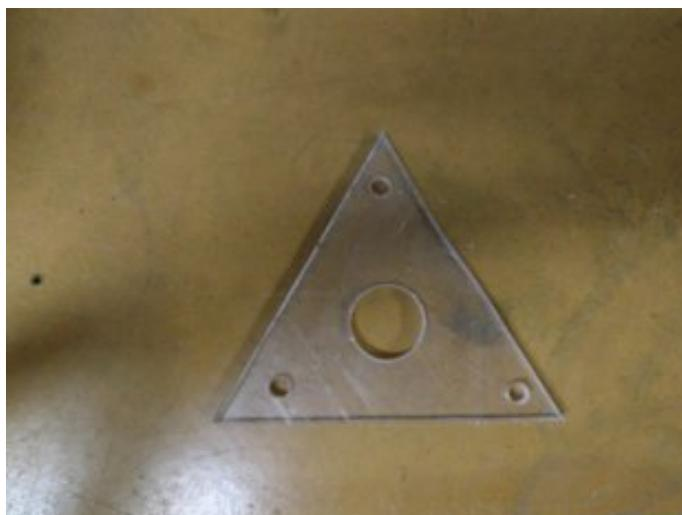
Figura 18: Resultado final dos cortes na peça de acrílico.
