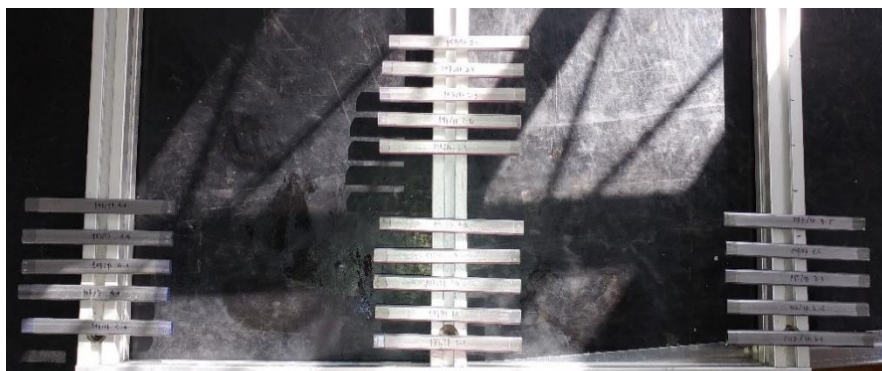
Figura 11. Corpos de prova cortados e identificados
