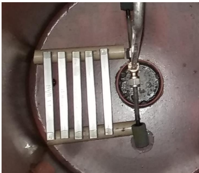
Figura 10. Corpos de prova dentro da cuba de teste.
