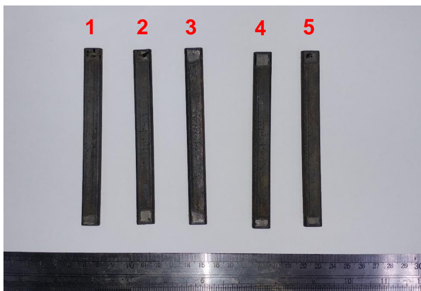
Figura 26. Amostras da condição pH 4.5 e 1000 ppm de H 2 S em CO 2 pós-teste
