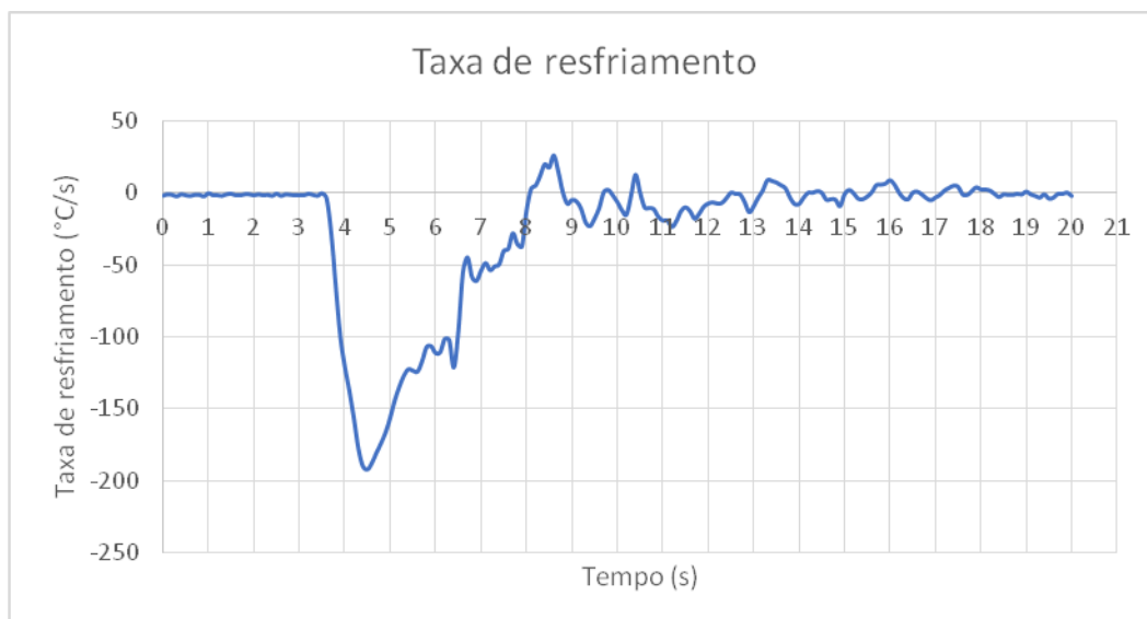
Figura 5.3 Taxa de resfriamento medido na amostra de controle (sem agitação). Fonte: Próprio autor.
