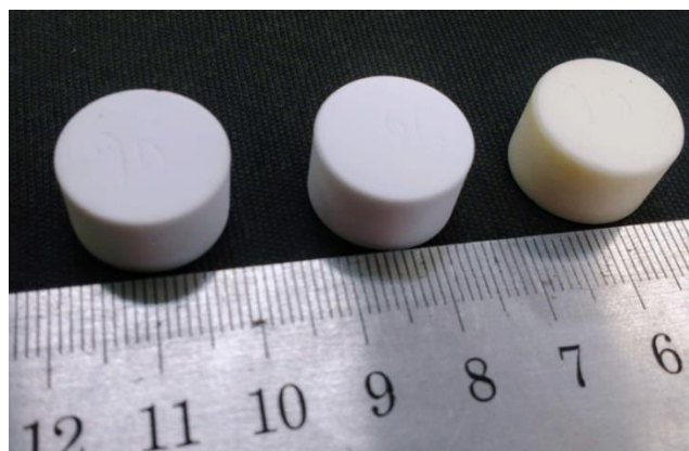
Figura 4.1 - Corpos de prova (CP) cerâmicos, da direita para a esquerda, com teores de 90, 96 e 99% de alumina.
