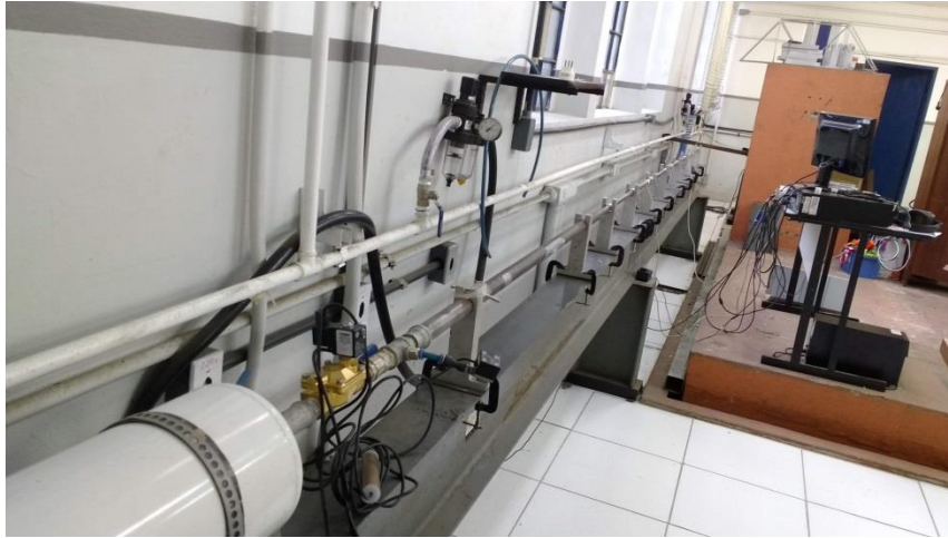
Figura 4.2 - Aparato barra de Hopkinson no laboratório do GMAp.
