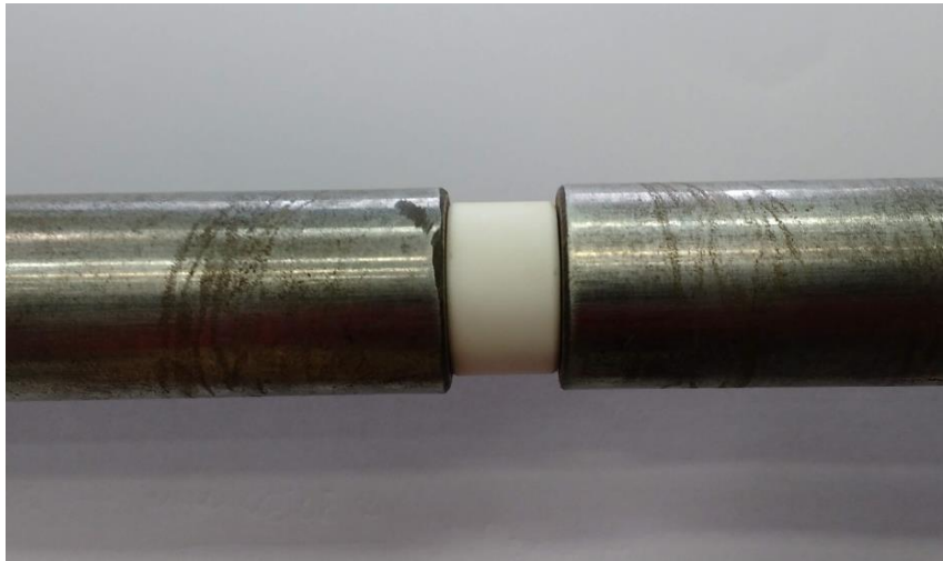
Figura 4.4 - Corpo de prova posicionado entre as barras incidentes de transmitida.
