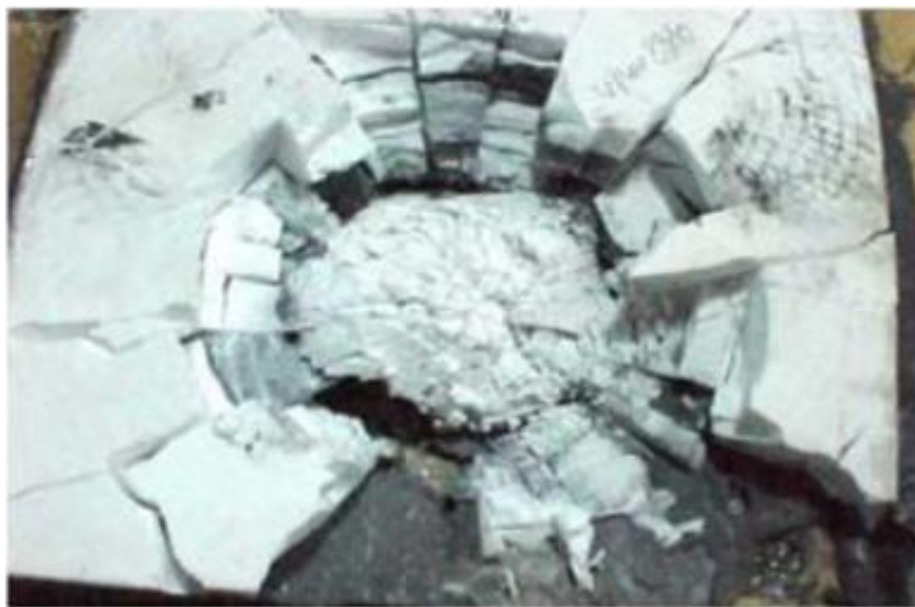
Figura 2.3 – Vista frontal da pastilha cerâmica (evidenciando tipos de falha, pulverização no centro e fraturas radiais e circulares adjacentes) após impacto balístico (Da Silva, 2013).
