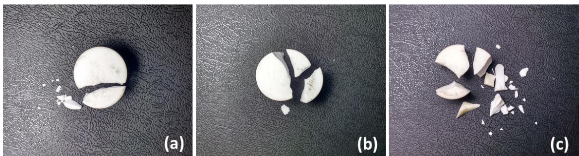
Figura 5.2 - Amostras quebradas após ensaio. 90% (a), 96% (b) e 99% (c).
