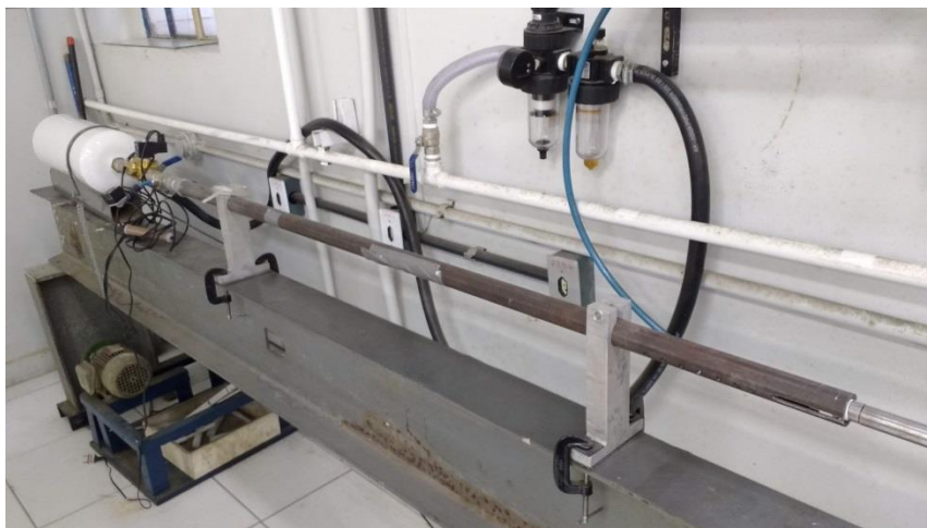
Figura 4.3 - Arma de gás comprimido com disparo por válvula solenoide.
