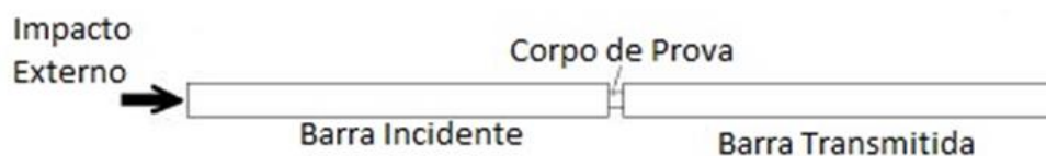
Figura 3.2 - Esquema simplificado do aparato Barra de Hopkinson (Pinto, 2009).
