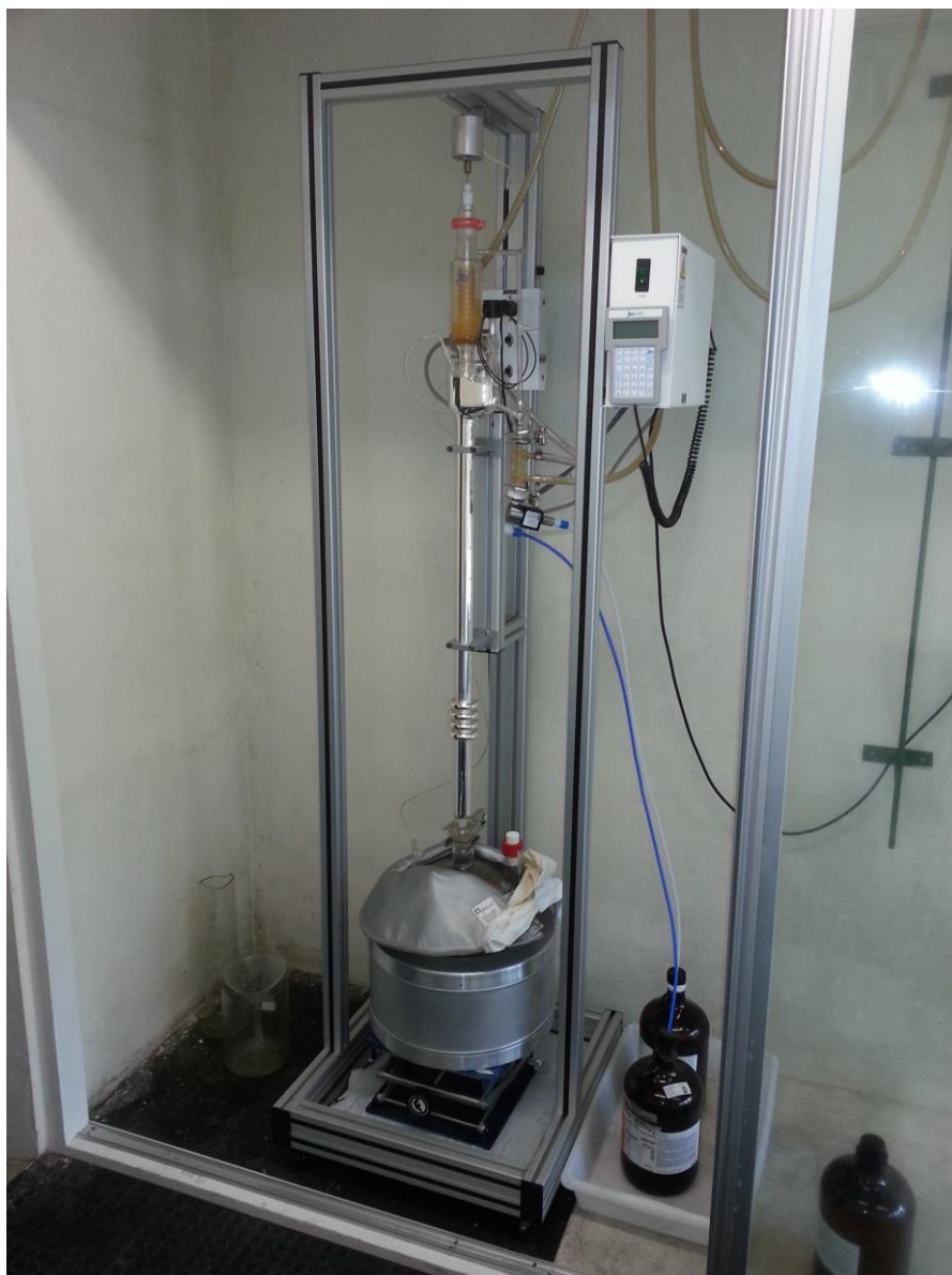
Figura 8 – Foto do Destilador Spinning band localizado no Laboratório de Purificação de Solventes no CGTRQ
