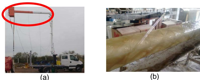
Figura 1.1 – (a) Layout da realização do ensaio de carga com registro de emissão acústica e (b) detalhe da fabricação lança de PRFV.
