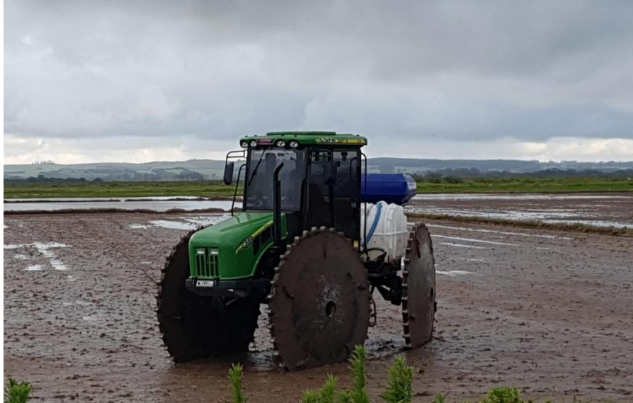
Figura 9: Semeadura de arroz no sistema pré-germinado com trator auto propelado (“chupa cabra”).
