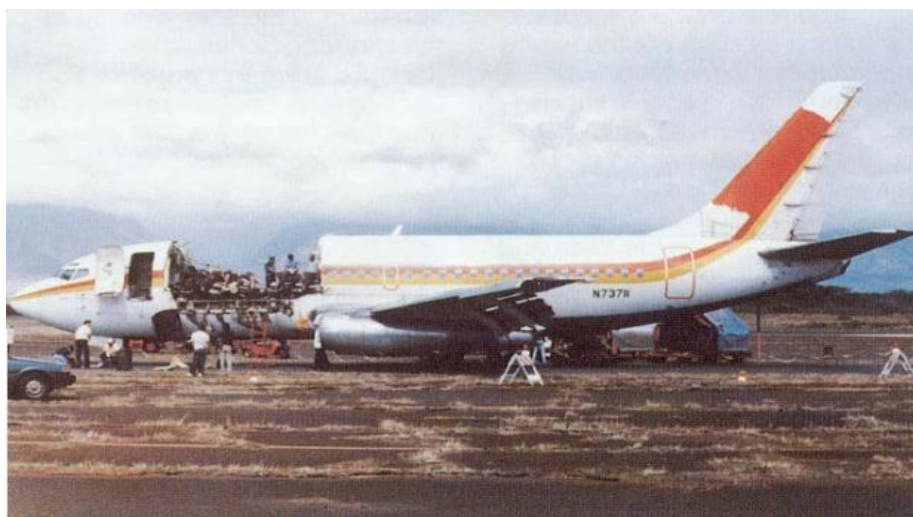
Figura 2.1 - Boeing 737 Aloha Airlines (1988) após perder parte de sua fuselagem
