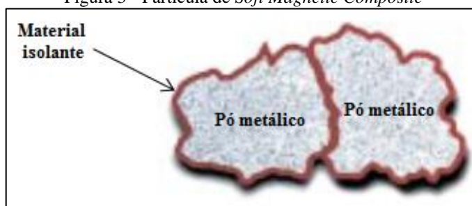
Figura 3 - Partícula de Soft Magnetic Composite
