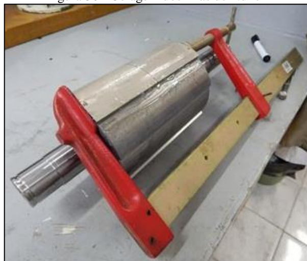
Figura 30 - Colagem dos ímãs de NdFeB
