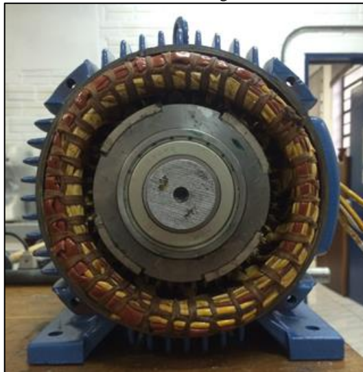
Figura 32 - Vista frontal da montagem do rotor e do estator
