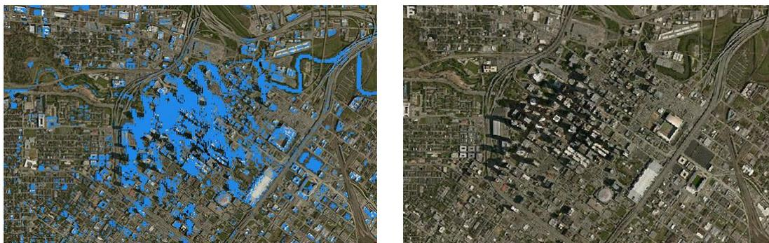
**Figura 28.** Exemplo da superestima da máscara de água MNDWI e Imagem do local sem a sobreposição da máscara d'água.
