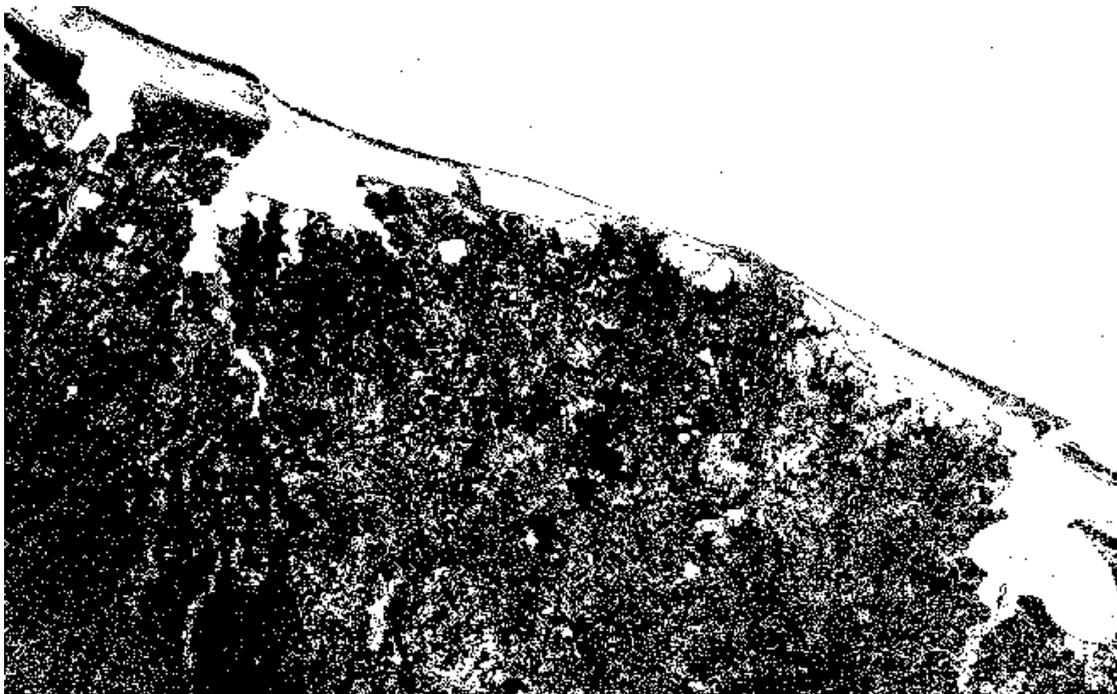
**Figura 25.** Imagem 1S após a binarização, adotando o limiar 0,022. Áreas brancas classificadas como água e pretas como “não-água”. Fonte: Elaboração própria
