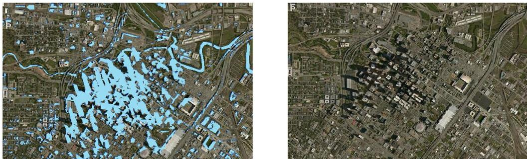
**Figura 27.** Exemplo da superestimação da máscara de água NDWI e Imagem do local sem a sobreposição da máscara d'água.
