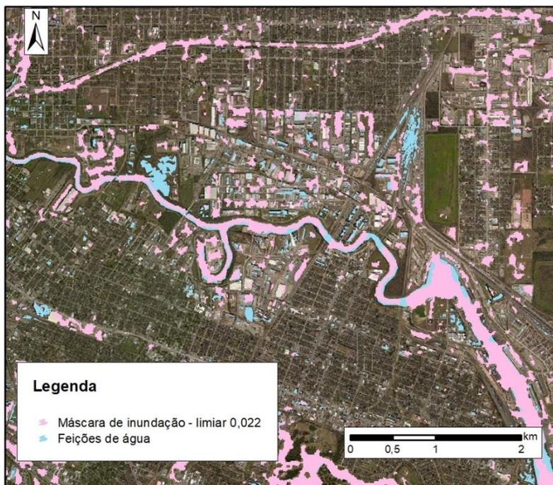
**Figura 44.** Amostra da comparação entre a máscara de inundação gerada (limiar 0,022) e a máscara de água. Fonte: Elaboração própria.
