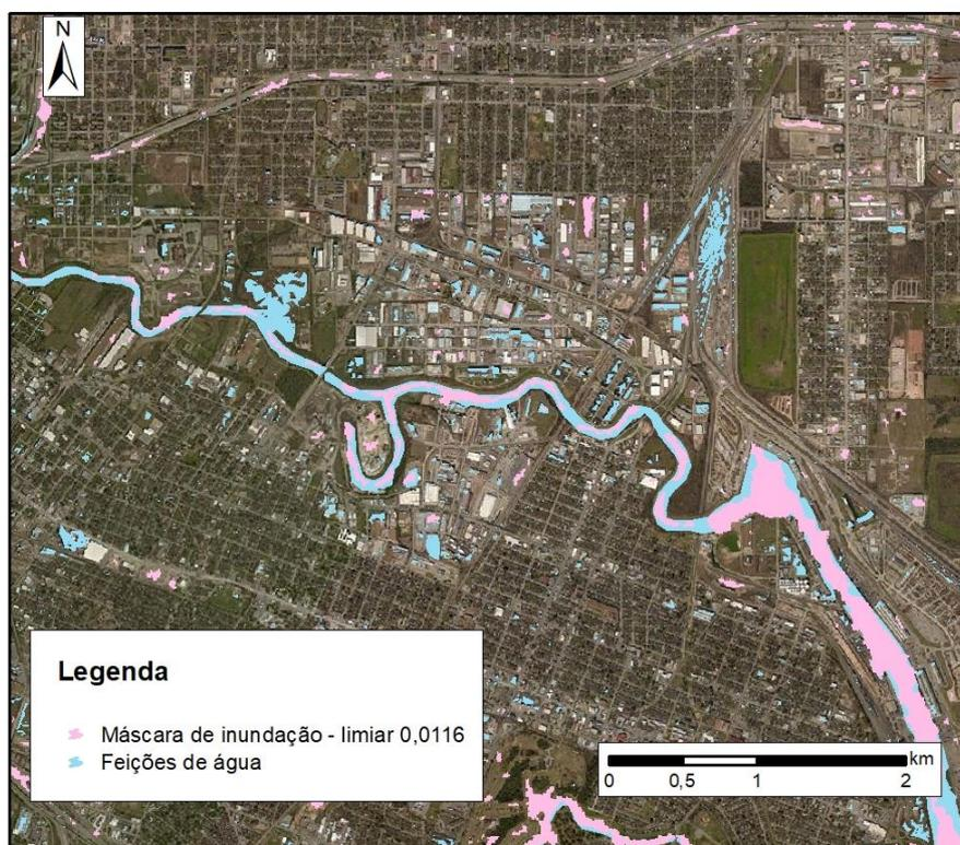
**Figura 42.** Amostra da comparação entre a máscara de inundação gerada (limiar 0,0116) e a máscara de água. Fonte: Elaboração própria.
