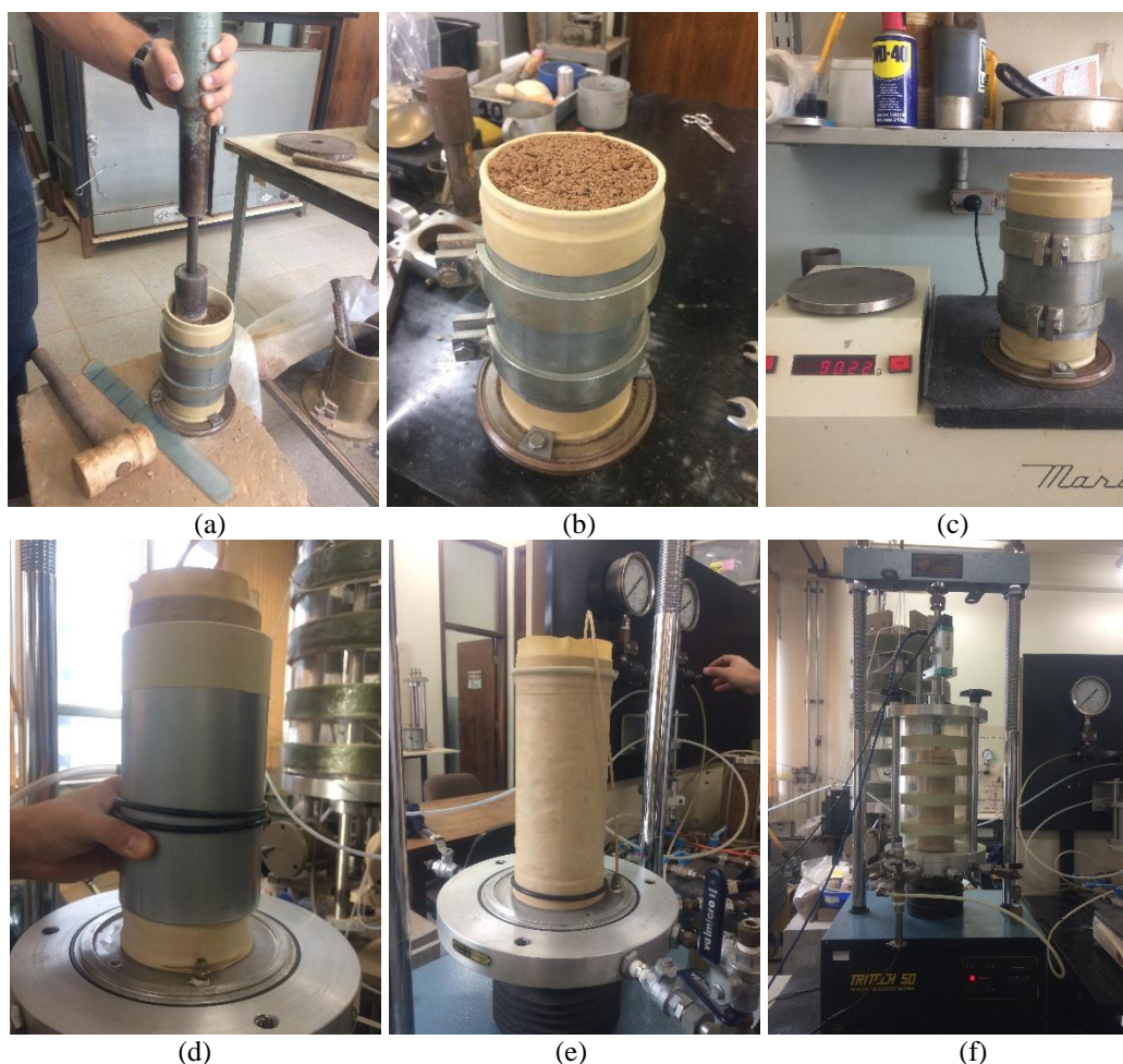
Figura 17 – Procedimento de ensaio de cisalhamento: a) equipamento utilizados para a compactação do corpo de prova – molde metálico, membrana de látex, régua, espátulas e soquete b) corpo de prova compactado c) determinação do peso do conjunto molde e material d) colocação da segunda membrana e) posicionamento do corpo de prova no equipamento de ensaio f) câmera triaxial para a realização do ensaio
