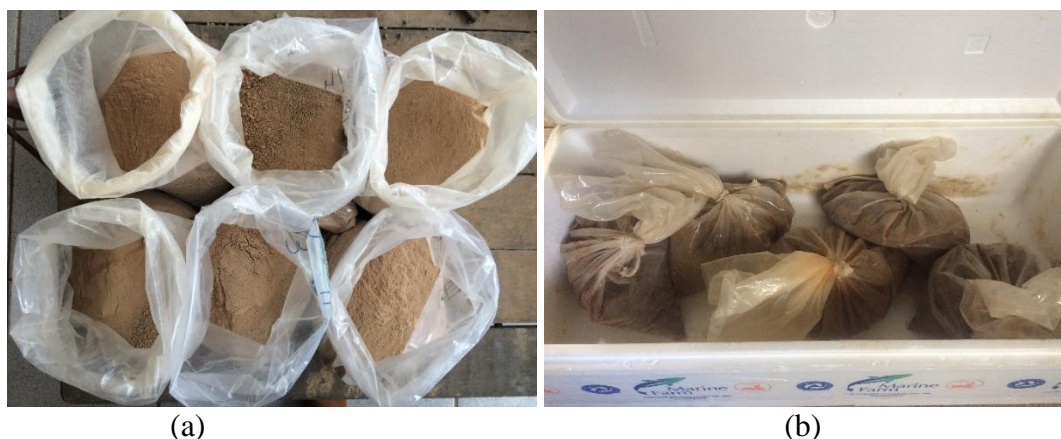
Figura 15 – Preparação do material: (a) dosagem dos corpos de prova (b) após umedecidos, amostras armazenas em caixa de isopor vedada para evitar a perda da umidade
