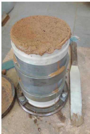
Figura 47- Exsudação de água no ensaio de GC 106%
