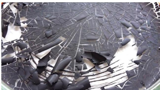
Figura 22 – Sólidos não voláteis para determinação do rendimento por gravimétrica.
