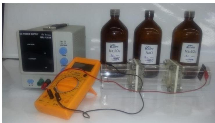
Figura 26 - Sistema de eletrodialise para ensaio de bancada com célula de três compartimentos.
