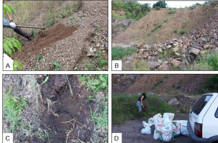
Figura 11 - Coleta de rejeito oriundo de pedreira de basalto (A), vista geral da pilha de rejeito da mina (B), coleta de solo de cobertura (C) e materiais acondicionados em sacos (D)
