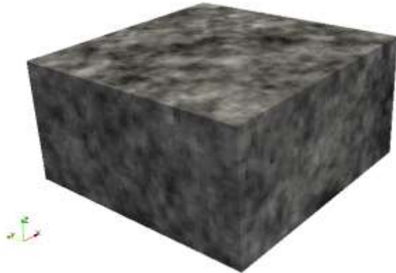
Figura 9: Campo estocástico para el módulo de elasticidad del suelo generado con la versión tridimensional del método LAS. Fuente: Elaboración propia.
