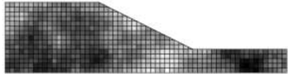
a) Malla de EF correspondiente a la simulación N° 1
