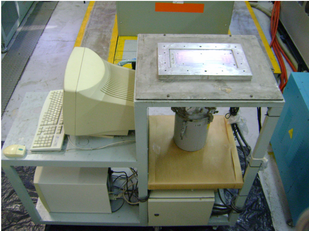
Figura 10 - Equipamento de RTM utilizado.
