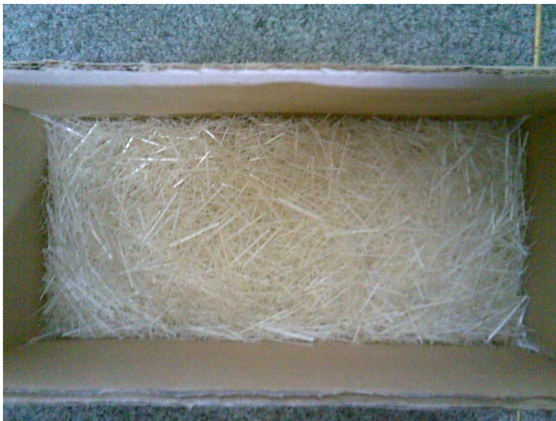
Figura 12 - Manta do compósito produzida manualmente.
