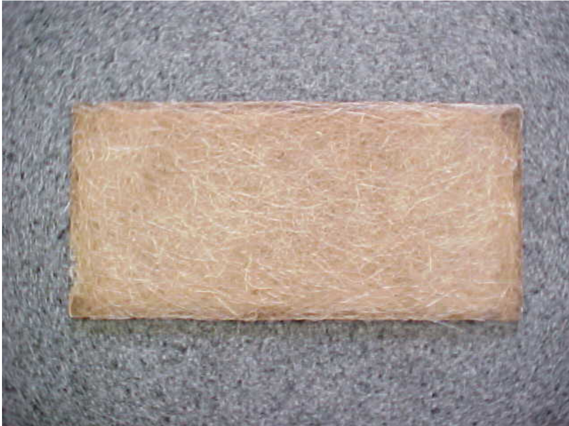
Figura 13 - Placa de um compósito fabricado por RTM
